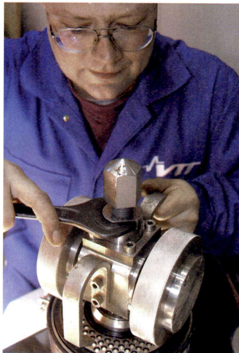
Amandus-Kahl 14-175:n kolleripyörien ja matriisin ilmavälin asettaminen vaatii tarkkuutta (kuva VTT).
