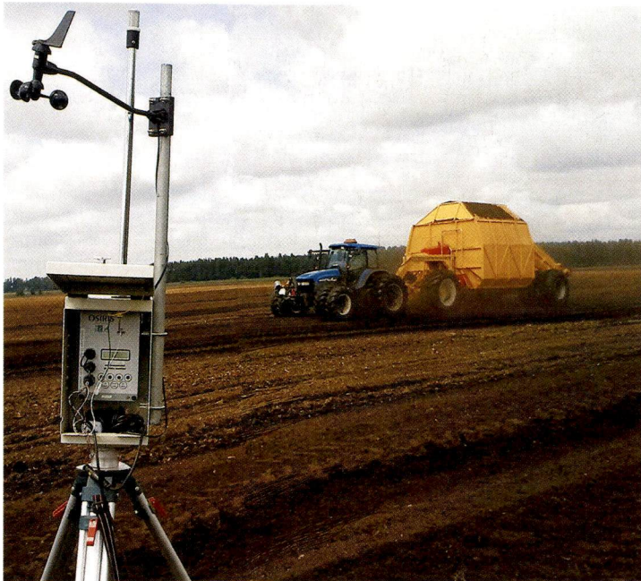
↑ Jatkuvat toimista mittauslaitteistoa Sammalistonsuolla rekisteröimässä viereisen saran mekaanisen kokoojavaunun pölypäästöjä. Kuva Ramboll Oy.
