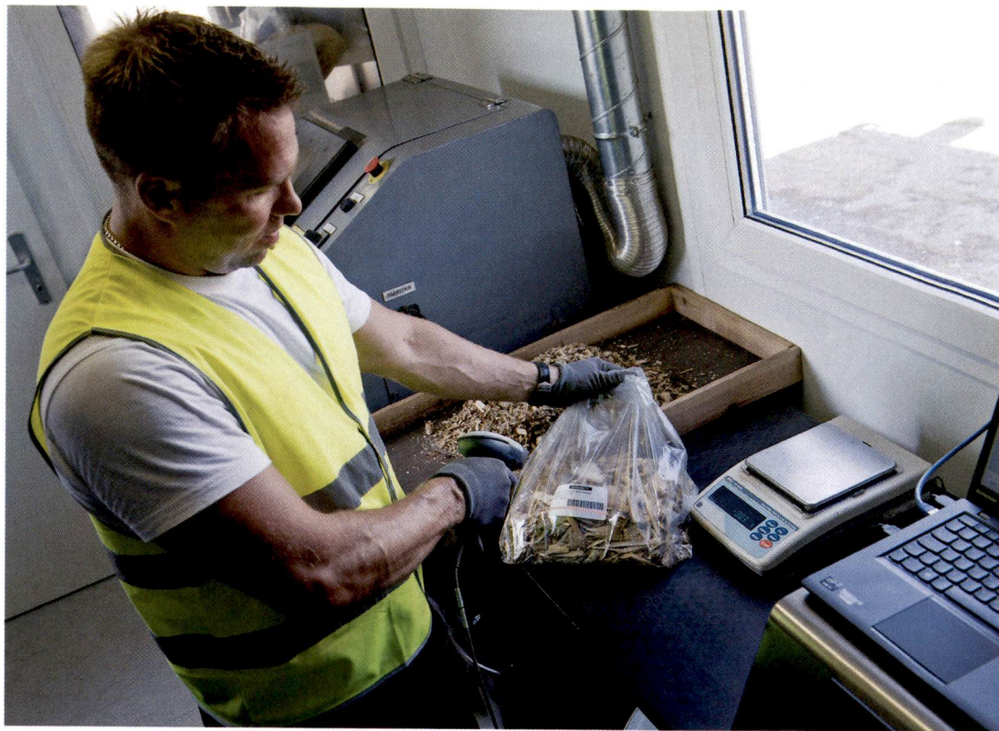
↑ Pikamittauksella saadaan nopeasti tuloksia kosteudesta, mutta luotettavasti vain pakkaskauden ulkopuolella. Laskentamallien perusteella saadaan suuntaa antava kosteustieto ympäri vuoden.
