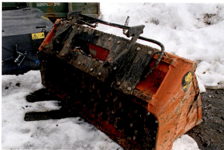
↑ Biojäte murskataan traktoriin kiinnitettävällä Allu-kauhalla.
