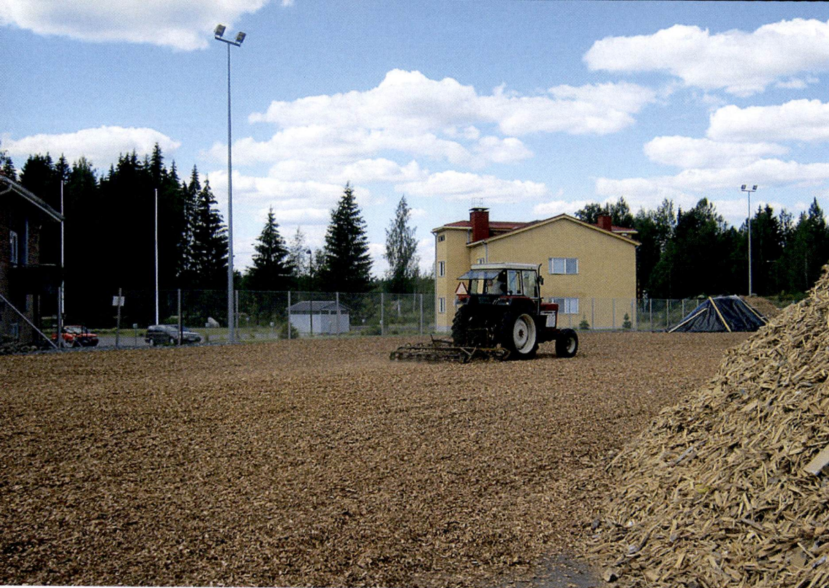
↑ Kaikkein kuivimmat hakkeet kuivattiin levittämällä ne ohueksi kerrokseksi asfalttikentälle ja kääntämällä niitä päivittäin. Kuva: Antti Heikkinen.
