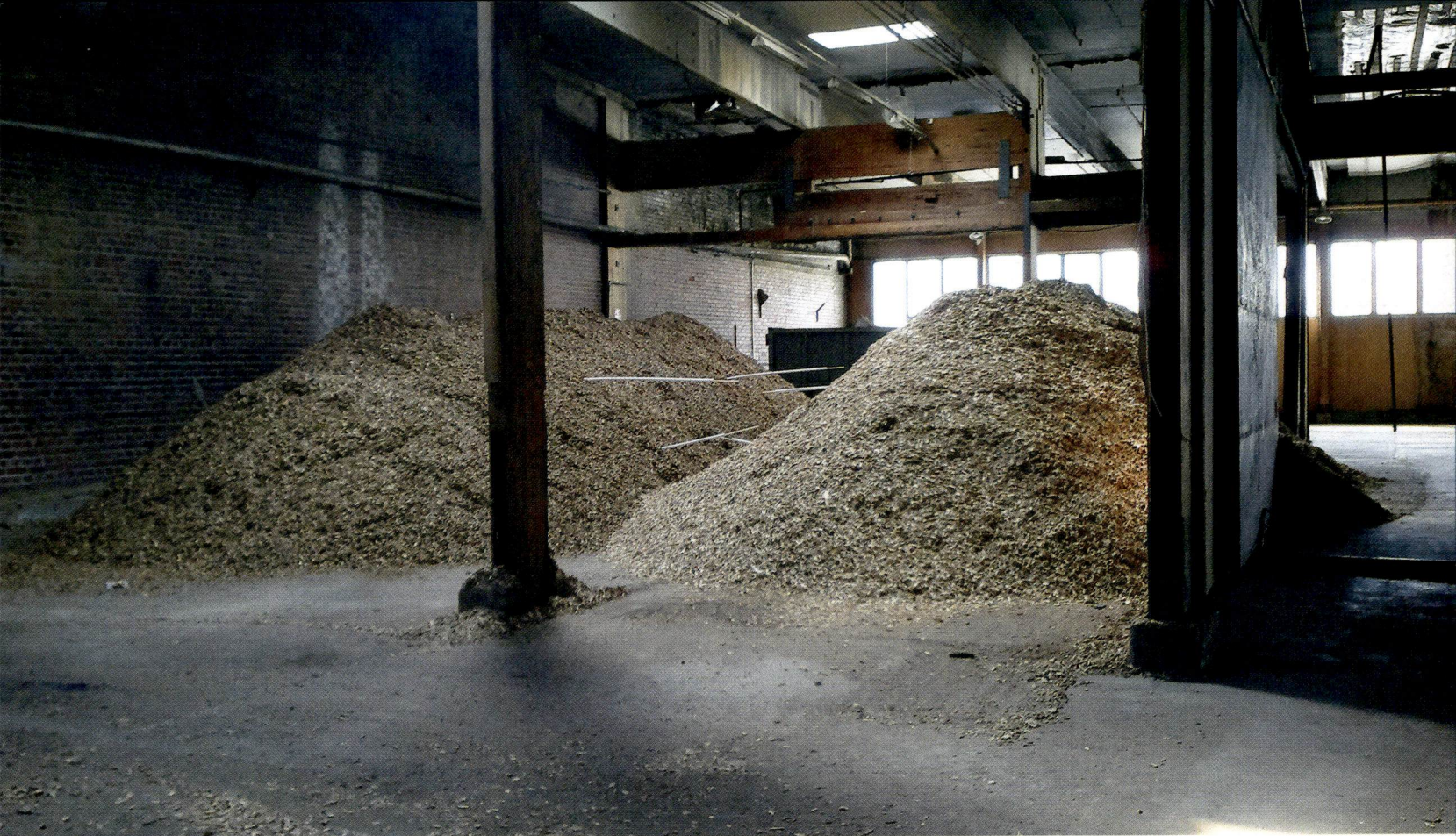
↑ Kylmään varastohalliin sijoitetut kokopuu- (vasemmalla) ja rankahakekasat (oikealla). Kuva: Antti Heikkinen
