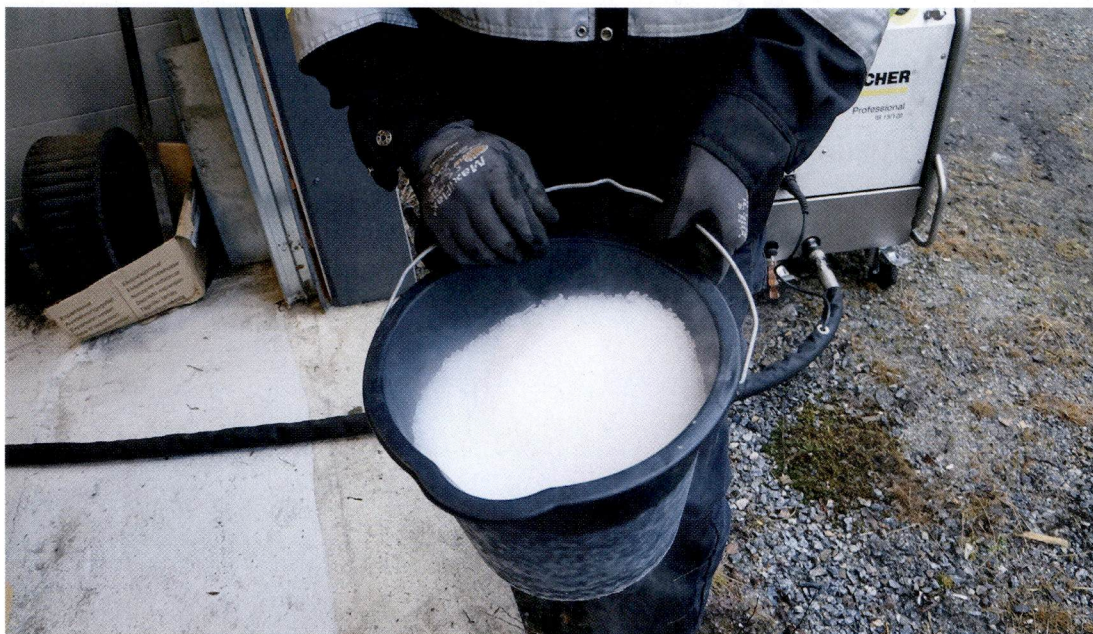
↑ Kuivajää on -78-asteista hiilidioksidia, joka huoneenlämmössä nopeasti muuttuu kaasuksi.
