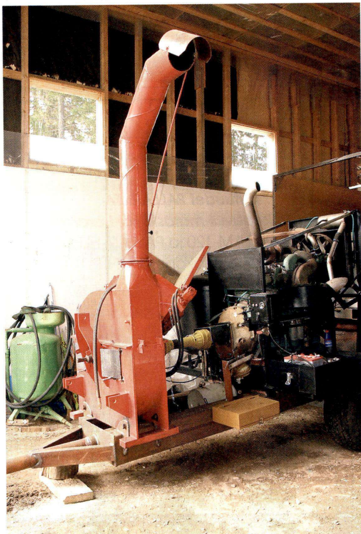
Hakkurin moottorina on järeä kuutos-Volvo, joka pyörittää painavaa laikkaa suoralla välityksellä. Kourakuormain asennetaan aisalle hakkurin eteen.
