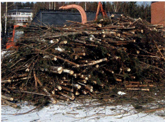
Laikkahakkurin syöte ja tuote, joka ajettiin JKP-murskaimeen.
