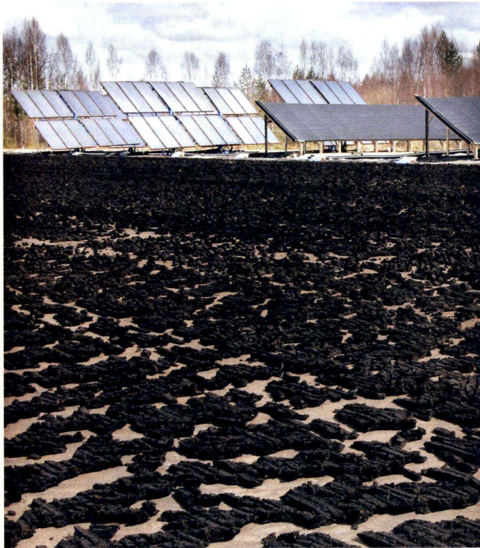
Aurinkopaneelien avulla auringon energiaa pystytään hyödyntämään biomassan kuivaamisessa huomattavasti aikaisempaa tehokkaammin. Kihniön Aitonevalla aurinkopaneeleja on yhteensä 730 neliometriä, mikä tekee siitä Suomen suurimman aurinkopaneelikentän.
