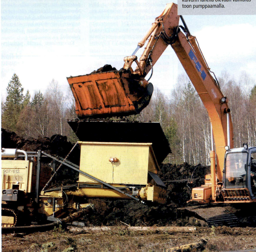
Uudessa tuotantomenetelmässä turve irrotetaan ojitetusta suosta ja siirretään biomassakuivuriin pumppaamalla. Tehokas pumppu työntää turvetta putkea pitkin jopa kilometrin.
