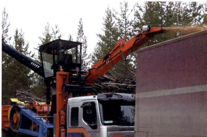
Tienvarsihaketus on yleisin pienpuuhakkeen tuotannossa tuotantoketju. Kuvassa Giant 8-rumpuhakkuri hakettaa ylivuotista kokopuuta.
