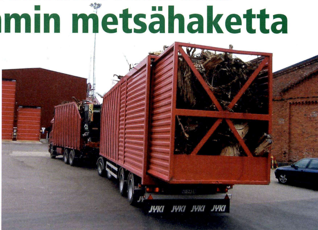
Kuljetettaessa kantoja, hakkuutähteitä tai pienpuuta käyttöpaikalle ensiarvoisen tärkeää on maksimoida kuormakoko lain sallimissa rajoissa. Tähän päästään isoilla, tilavuudeltaan 150–170 kuutiometrin täysperävaunuyhdistelmillä sekä täyttämällä ja tiivistämällä kuorma hyvin. Kuvassa kantokuorma saapuu Jämsänkosken Voima Oy:n käyttöpaikkamurskaamoon. Kuva: UPM Metsä
