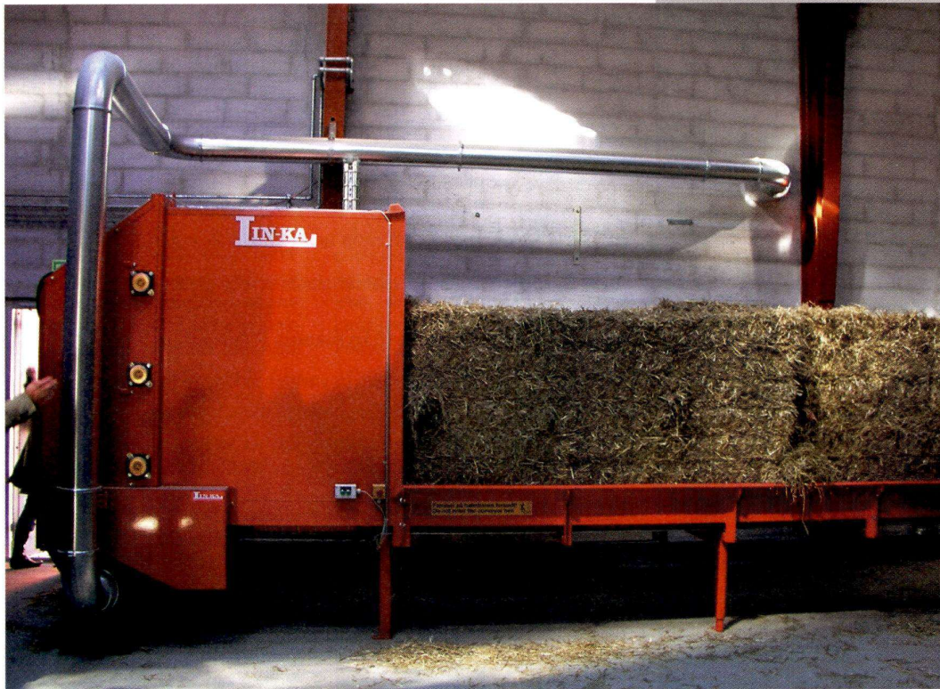
Oljen syöttö kantipaaleina silppuriin Onsbjergin lämpölaitoksessa
