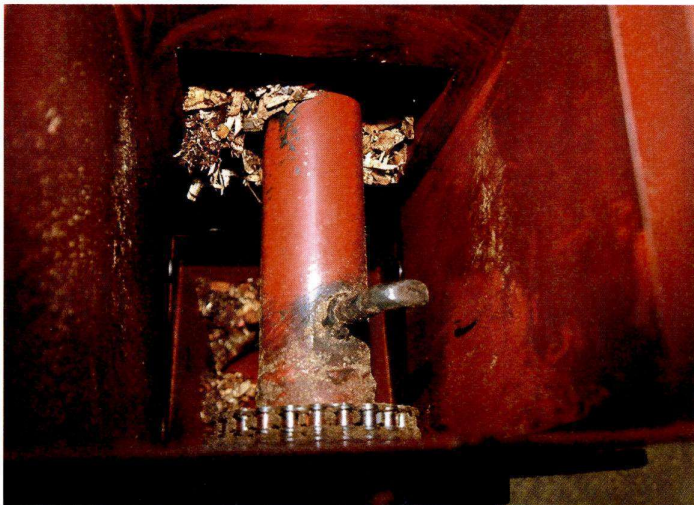
Ruuvinakseliin hitsattu leikkaava kynsi katkoo tikut, jotta ne eivät pääse aiheuttamaan häiriöitä.
