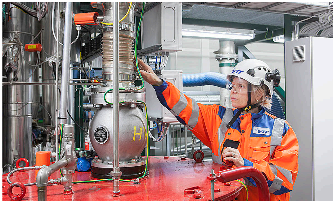
↑ VTT:n kiertoleijupetikoelaite (20 kg/h), jolla on tehty ligniinin pyrolyysiä.
