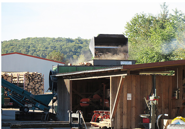
↑ Polttopuun puhdistamisen ja kuivauksen kuuma linja. Koko linja on siirrettävä, myös 150 kilowattitunnin hakkeella toimiva konttikuivuri hakekattiloineen. Polttopuun hinta haettuna on 70–75 euroa irto-m 3 pituudesta riippuen.
