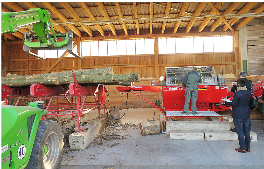
↑ Suomalainen tekniikka pärjää polttopuutehtaalla Baijerissa. Alle 35 senttimetrin pyökistä tulee tasalaatuisia polttopuuta. Järeämpi puu menee muuhun jalostukseen. Valmis polttopuu on 25 tai 35 senttimetrin pituista.
