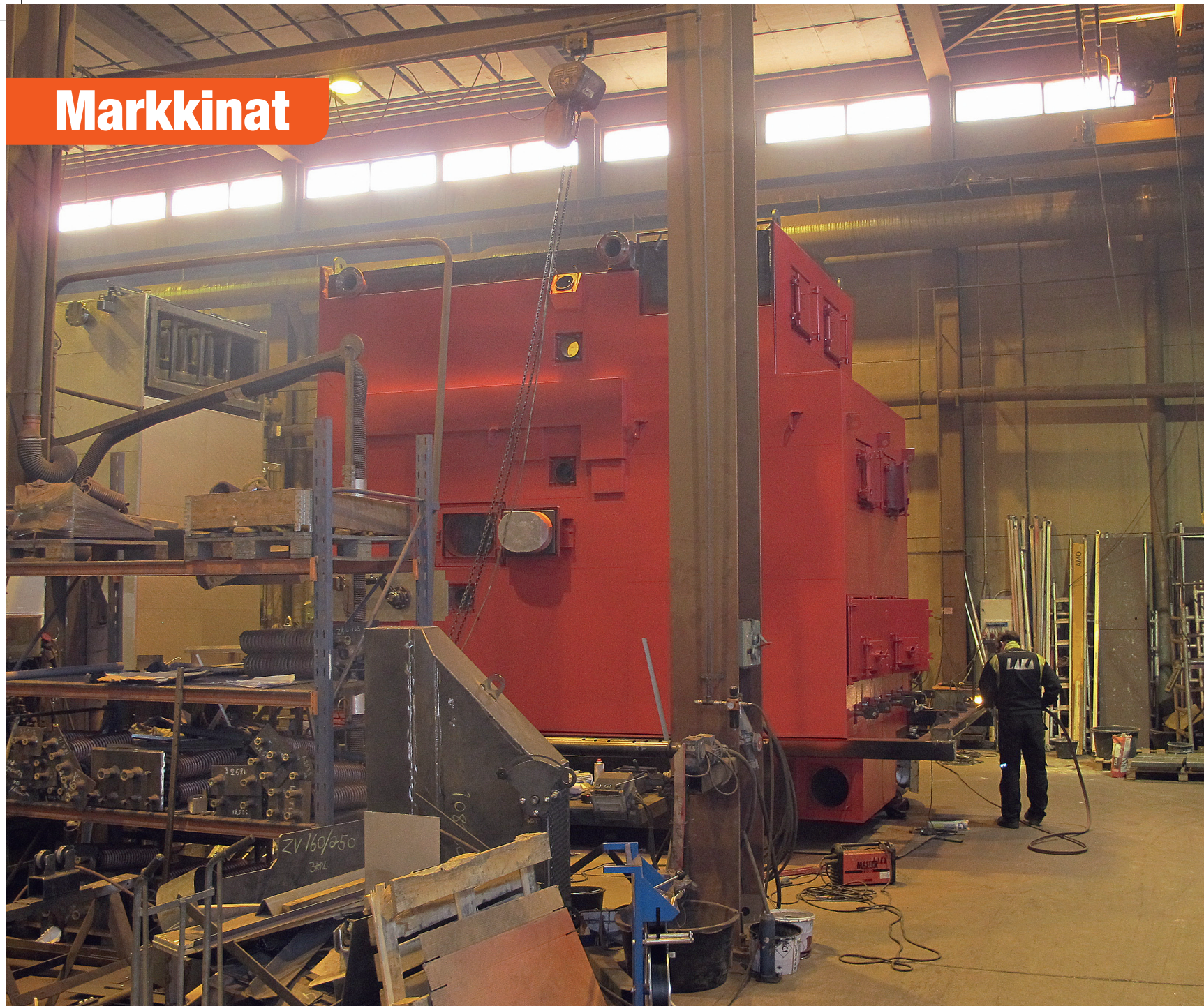
↑ Lakan kaasutuspolttokattila täyttää alle 5 MW lämpölaitosten päästövaatimukset ilman lisäpuhdistimia
