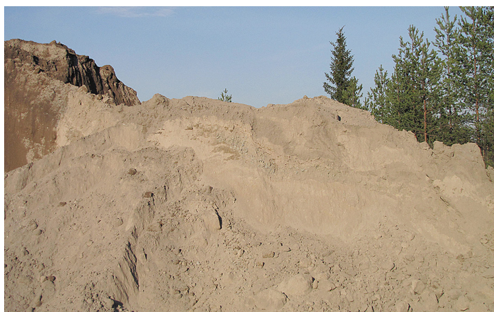
↑ Irtotuhkasta voidaan rakentaa metsätierunkoon tiivis tuhkapatjarakenne, joka peitetään murskekerroksella tai tuhkaa voidaan sekoittaa kalliomurskeeseen ja käyttää seosta metsätien päällysrakenteena. Kuva: Tommi Tenhola
