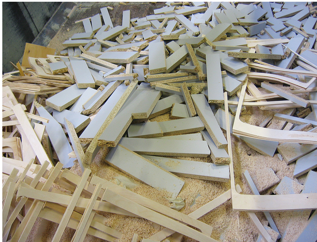
↑ Kierrätyspuuohjeen B-luokan puuta sekä I4 -laatulukuokan puutähdettä teknisen spesifikaation ISO/TS 17225-9 mukaan valmiina murskaukseen.
