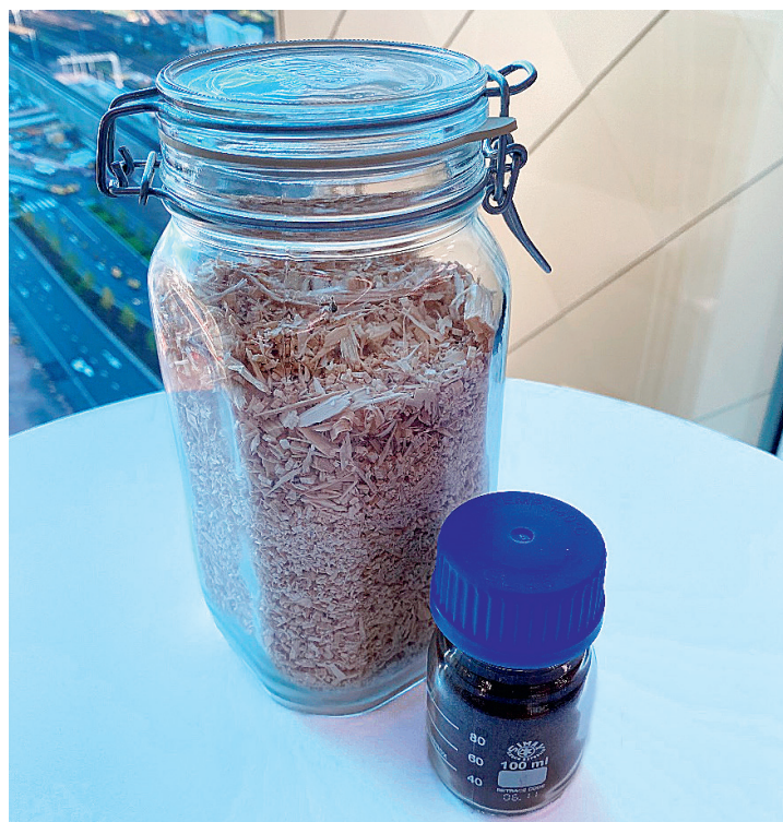
↑ Esimerkiksi metsäteollisuudesta peräisin olevat sahanpuru ja ligniini kelpaavat lainsäädännön puitteissa raaka-aineiksi kehittyneiden biopolttoaineiden tuotantoon. Toisaalta ligniiniä syntyy myös joissakin biopolttoaineiden tuotantoprosesseissa sivuvirtana.
