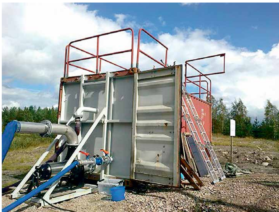
↑ Suodatinhiekkana kokeiltiin kalkkikivihiekkaa ja serpentiniittikivestä murskattua ja seulottua hiekkaa.
