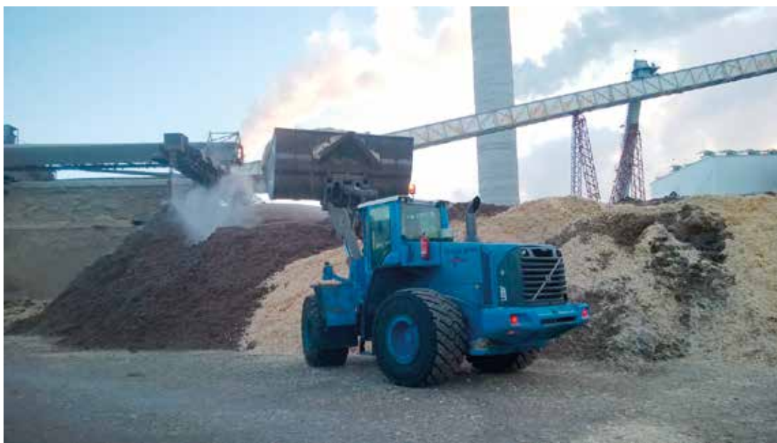
Hakevaraston suuruutta voidaan seurata terminaali-järjestelmässä pyöräkuormaajan punnituslaitteiden avulla.
