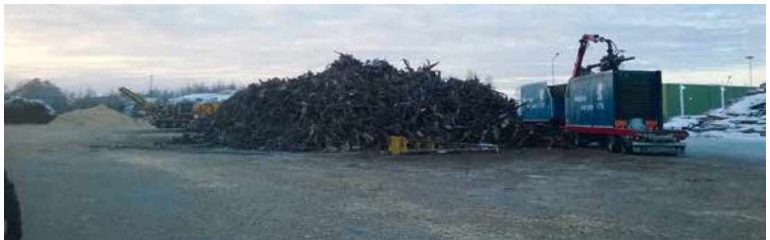
↑ Kantojen esimurskaus voidaan tehdä mobiilmurskaimella ja suuremmissa termiinaaleissa kiinteällä murskalla.
