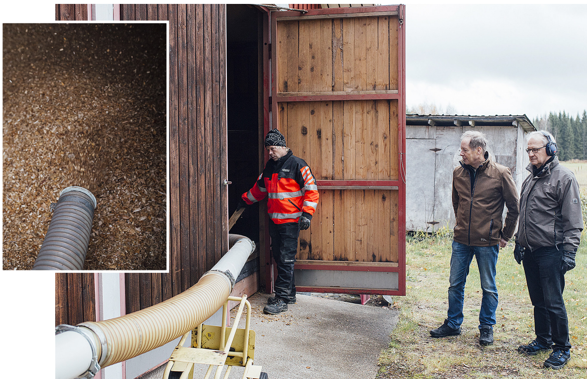
↑ Lassi Tervo puhaltaa haketta omakotitalon polttoainevarastoon. Puhaltimen etuna on, että hakeautolla ei tarvitse päästä aivan lämpökeskuksen viereen, vaan hakkeen voi puhaltaa hankaliinkin paikkoihin.
