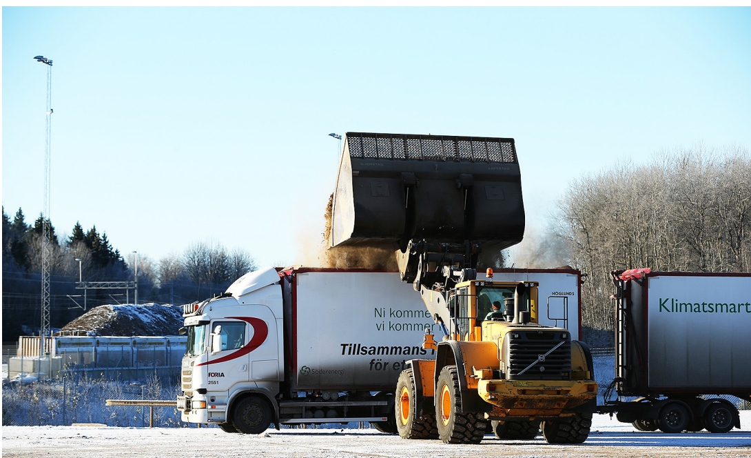
↑ Kuljettaja kuormaa etukuormaajalla, peittää kuorman ja ajaa vaa'an kautta ennen kuin lähtee Igelstaan.
