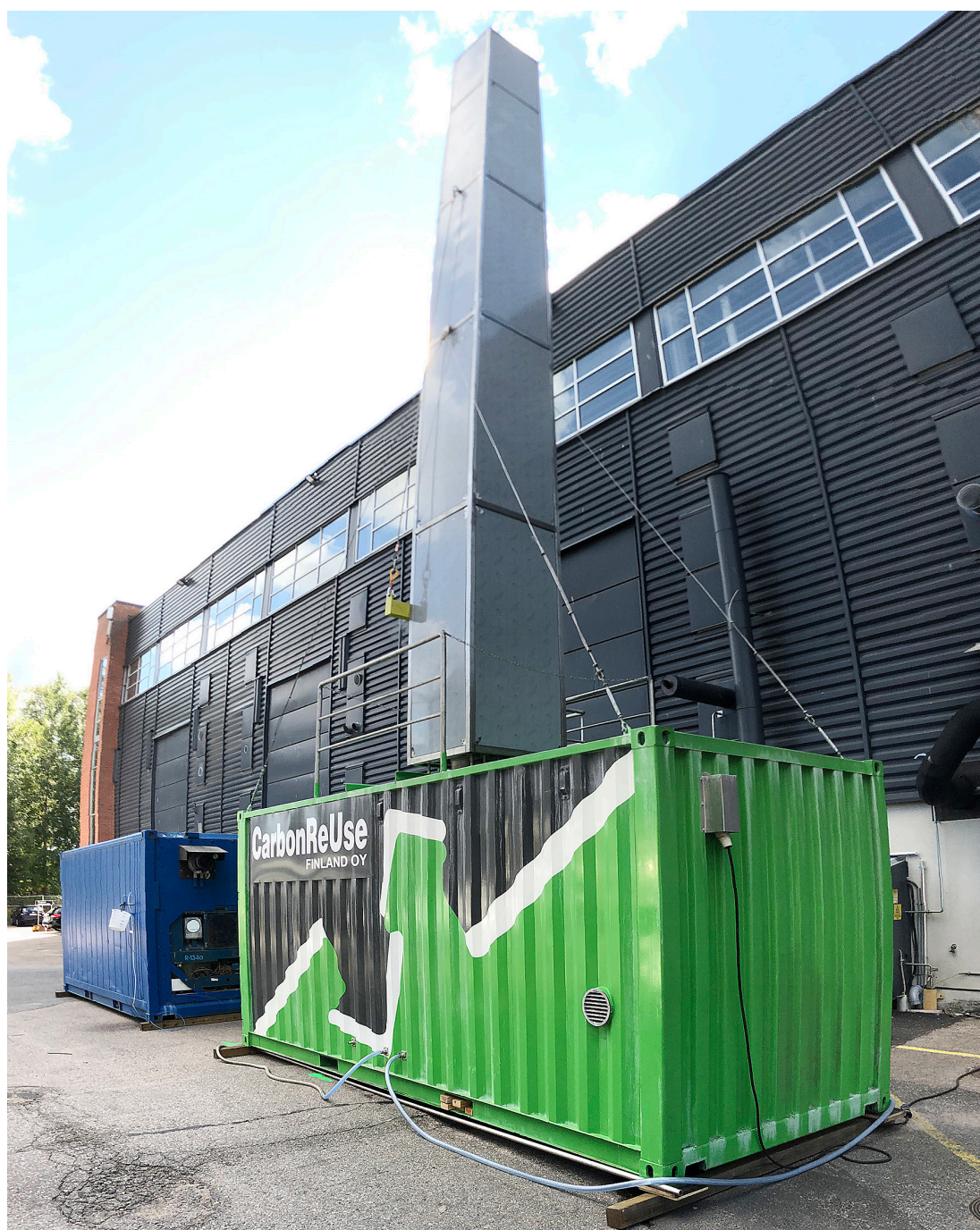
↑ Talteenottokokeet toteutettiin pilottimittakaavassa merikuljetuskontteihin rakennetuilla koelaitteistoilla.
