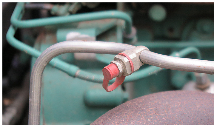
↑ Sammutusjärjestelmään kuuluu riittävä määrä suuttimia oikeissa paikoissa.
