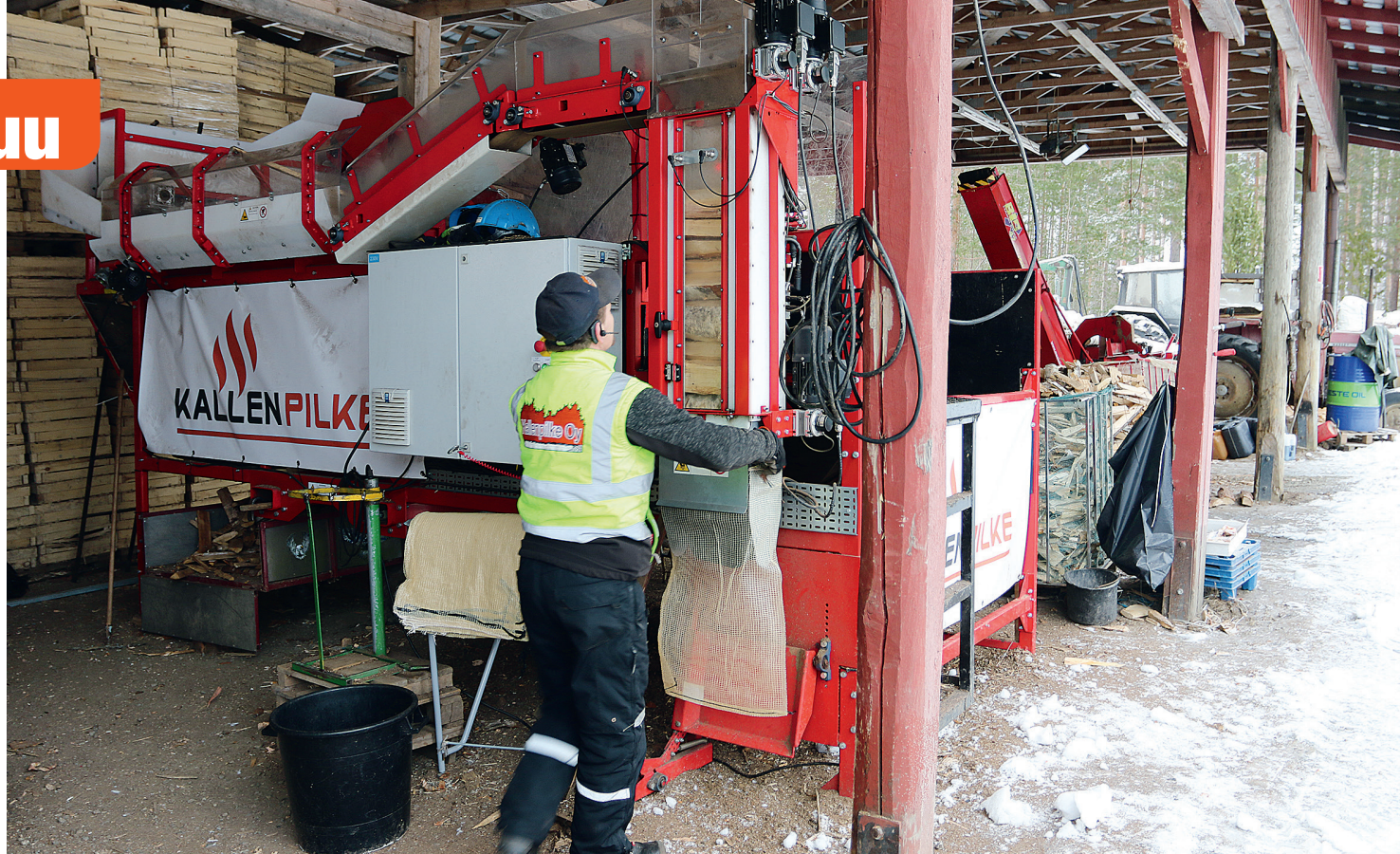
↑ Klapit pussitetaan Vepakin pussituskoneella. Varastosäiliö täytetään kuormaajalla ja klapit juoksevat kuljettimia pitkin säkkiin.
