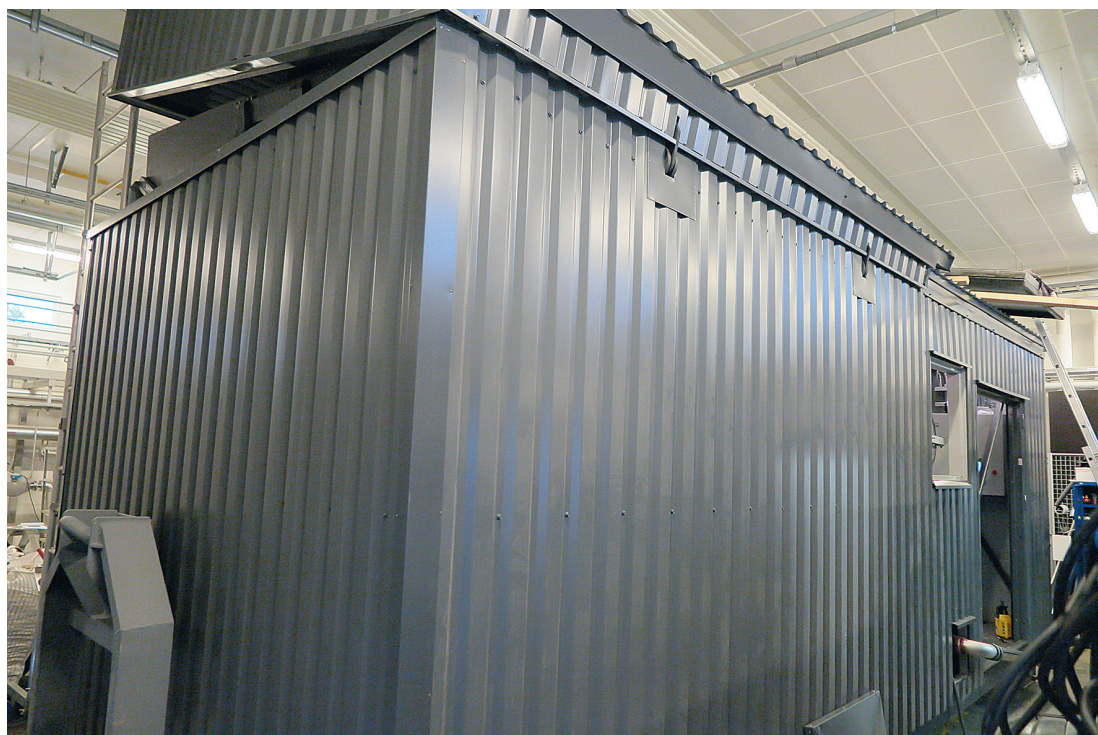
↑ Konttiratkaisu on tiivis siirrettävä paketti, teholtaan 170 kilowattia.
