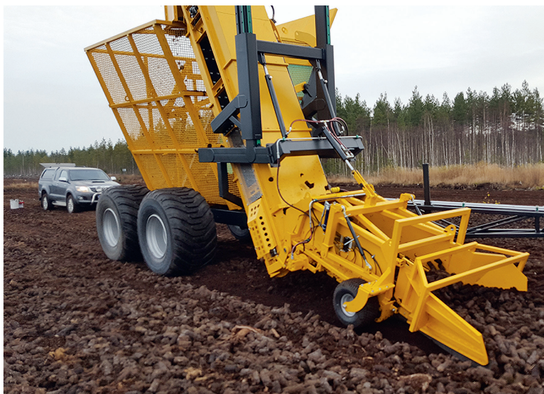
↑ Ratkaisuja joustavaan tuotantoon pieneneville tuotantopinta-aloille: Palaturpeen mekaaninen kokooja-vaunu PMK-15
