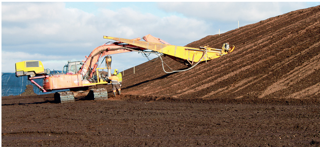
↑ Aumakairauksen avulla saadaan auman eri puolilta ja eri kerroksista luotettavat näytteet laboratorioanalyysejä varten. Kuva: Vapo Oy
