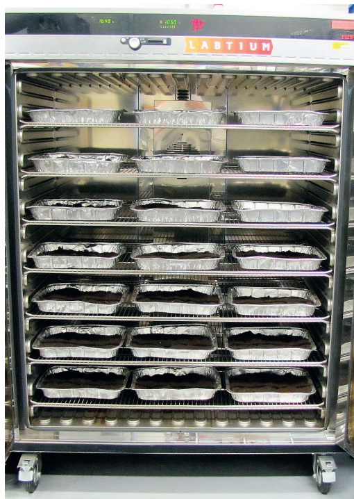
↑ Turpeen kosteuden määrittäminen. Kuva: Labtium Oy.
