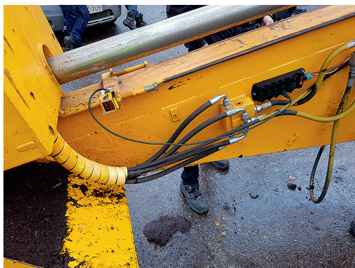
↑ Aumakairan lasermittaussysteemi tarkkaan syvyyden, sijainnin ja paikan jäljitettävyyteen.
