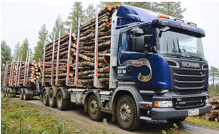
Siirtyminen 76-tonnisiin, osin jopa isompiin, puutavara-autoihin tehostaa kuljetuksia huomattavasti.
