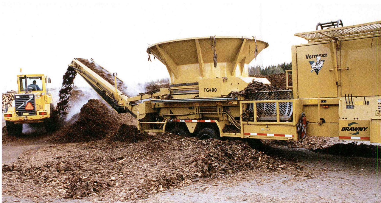
Vermeer kaukalomurskain on puoliperävaunualustalle kiinteästi rakennettu omalla voimalaitteella varustettu laitteisto. Yhdellä pyöräkuormaajalla ehtii sopivasti täyttämään kaukalon ja siirtämään lopputuotteen kuljettimen alta pois. Pyöräkuormaajan kuljettaja Petri Kinnunen toimii aliurakoitsijana Pohjaset Ky:llä.
