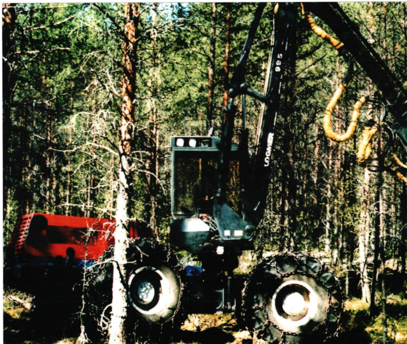
Kaatokasauskone työmaallaan Keski-Pohjanmaalla. Timberjack 720 keräilevä kaatopää on asennettu käytettyyn koneeseen.
