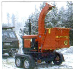
Junkkari HJ 500 Contractor täyspäiväiseen urakointiin. Sähköhydraulinen kaukosäätö traktorin ohjaamosta.
