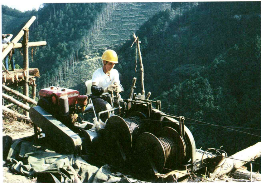
Puut juonnetaan tien varteen yleensä köysiratakuljetusta käyttäen.
