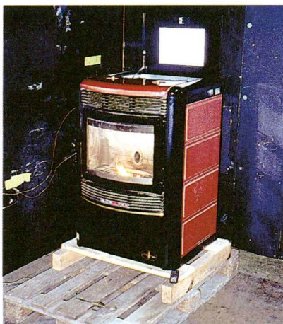
Pellettikamina testeissä P-merkintää varten SP:n tutkimuslaboratoriossa. Kokeissa määritetään mm. turvaetäisyys ympäröiviin seiniin, jolla seinän pintalämpötila ei ylitä 80°C. Kuva Kai Walden.
