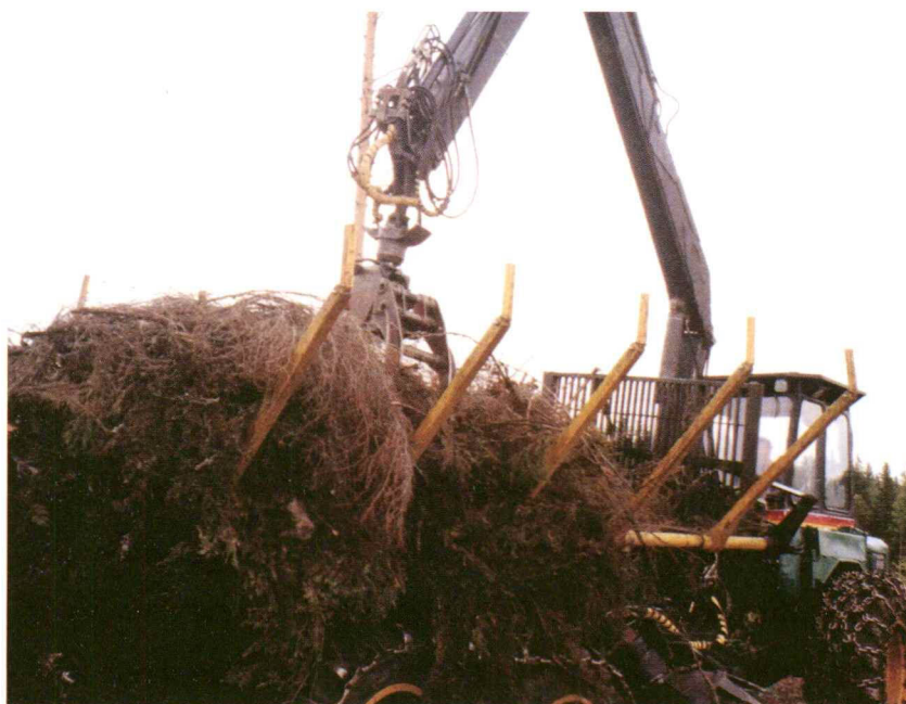
Taittavat laidat ovat kuormauksen ja purkauksen aikana tässä asennossa.
