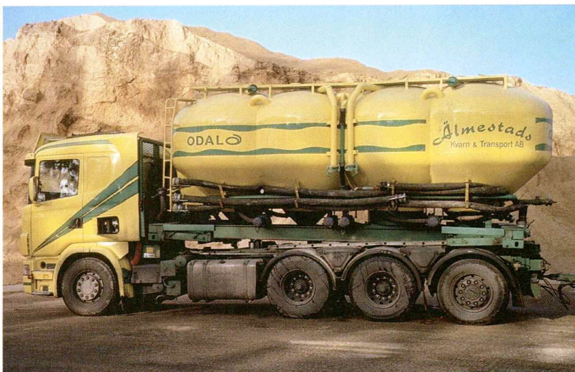
Kuvassa näkyy pellettien jakeluauto, josta pelletit siirretään pneumaattisesti asiakkaan varastoon. Taustalla näkyy Ulricehamnin pelletti tehtaan raaka-ainevälastoa. Kuva: Kai Waldén.
