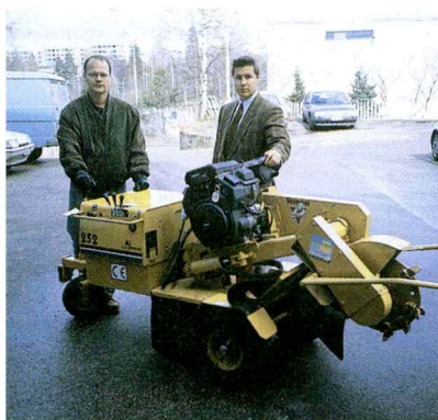
Several Oy:n toimitusjohtaja Patrik Wegelius vasemmalla näyttää, miten kantojyrsin toimii. Pyörivä terä liikkuu sivuttain kannon leveyden mukaan. Oikealla markkinoitipäällikkö Christopher Wegelius.
