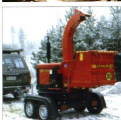
Junkkari HJ 500 Contractor täyspäiväiseen urakointiin. Sähköhydraulinen kaukosäätö traktorin ohjaamosta.
