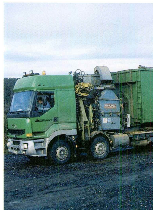
Sisu-autohakkuri. Yhdistelmä kuljettaa itse hakettamansa tuotteet
