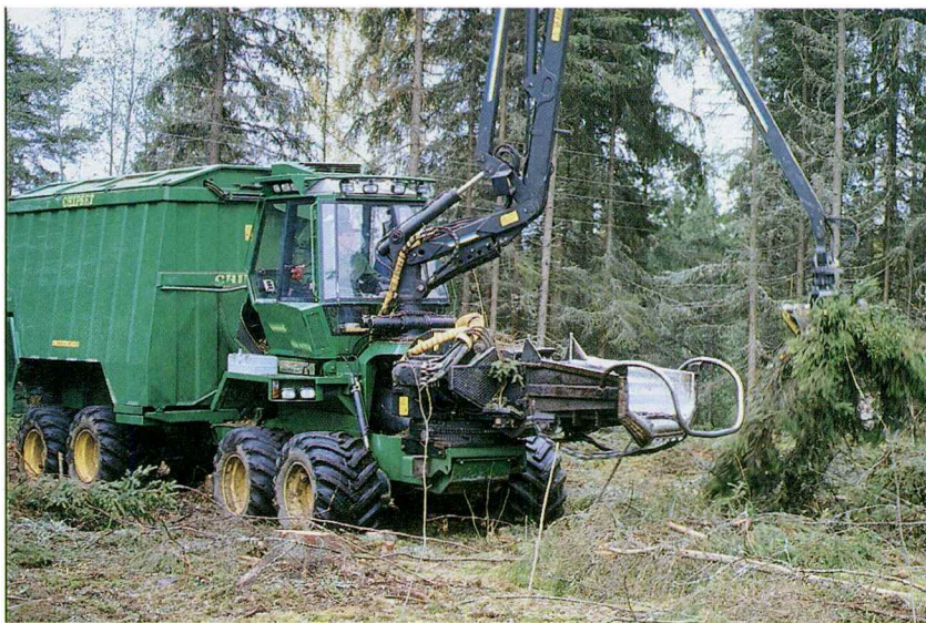
Chipset palstahakkuri liikkuu sujuvasti sekä harvennuksissa että päätehakkuu-aloilla.
