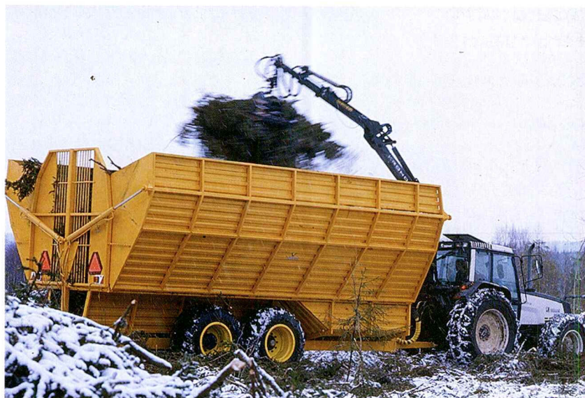
Hakkuutähdeperävaunu on tärkeä osa Vapon metsähakkeen tuottamiseen tarkoitettua terminaalituotantomallia. Oksat ja latvat kerätään siihen metsästä ja kuljetetaan terminaaliin.
