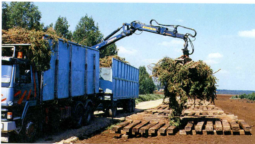
VTT Energia selvittää hakkuutähteiden kuivumista aumoissa. Alustavien tulosten mukaan parhaat tulokset saadaan kuivattamalla tähteet ratapölkkyistä rakennetun ilmavan alustan päälle.
