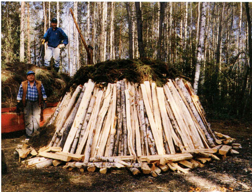
“Koivuhalo on ladottu alustan eli rostin päälle. Markku Tenho (kuorman päällä) ja Tapio Salmivalli (miilun vieressä) peittävät kukkuraa (lakia) havunoksin. Kullaa.”
