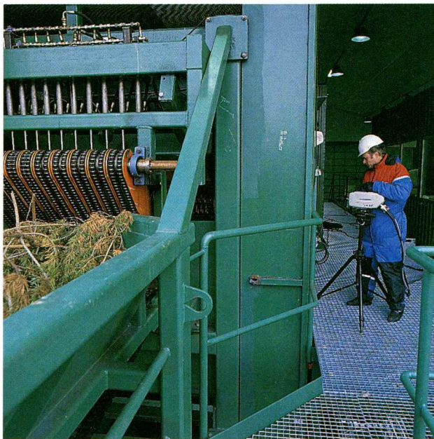
VTT Energian kokokuvaan käsittelylaitteistoon voidaan liittää suurnopeusvideokamera, jolla voidaan tutkia esimerkiksi nopeita kuorintailmiöitä. Kuva Tähtikuva.
