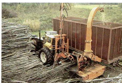
TT-1000 TU hakkureita käytetään yleisesti voimaloiden hakehuollossa (1978).
