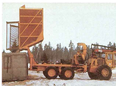
Lokomo-metsätraktorin kuormatilaan asennettu hakkuri ja kipattava säiliö (1976).
