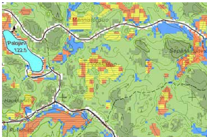
↑ Julkisiin tietolähteisiin perustuva maaston korjuukelpoisuusluokitus hylätasolle. Sekä aines- että energiapuun hankinnan kannalta erityisen merkityksellistä on maaston kantavuuden ennustaminen, johon Arbonaut on kehittänyt uuden apuvälineen. Kuva: Arbonaut Oy. Forest Big Data -hanke.
