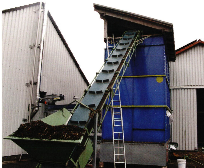
↑ Lämpöä käytetään hakkeen kuivatukseen ja polttopuiden kuivatukseen. Haketta kuivataan 50 kuution erissä
