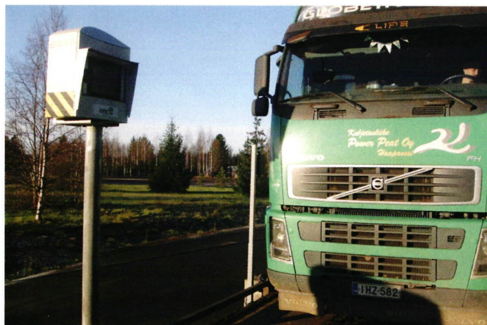
↑ Polttoainerekasta otetaan tulopaino ja lähtöpaino autovaa’alla. Rekka tulossa lähtöpunnitukseen.
