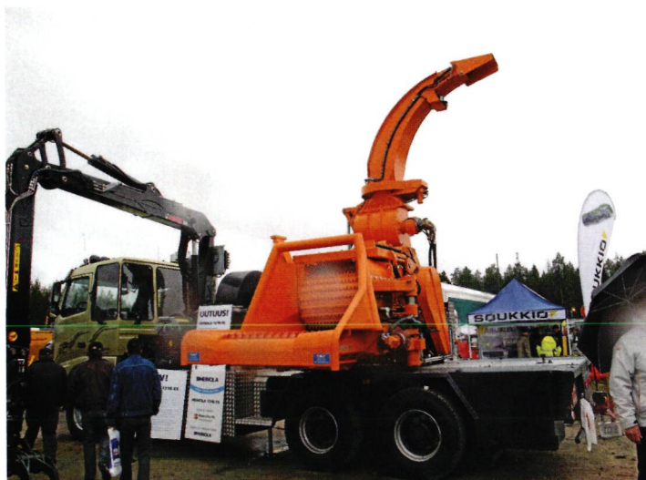
↑ Heinola 1310 S:n saa joko erillismoottorilla tai käyttö on ajoneuvon moottorilla. Hakkurin tehontarve on 370–600 kW (503–816 hv).
