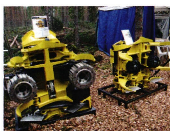
↑ Leikkaavilla terillä varustettujen koneiden heikkoutena on pidetty kantokäsittelyn tekniikan puutetta, mutta se on nyt ratkaistu ainakin Moisiolla. Tällä tavalla pystytään pysymään kehityksen kärjessä.
