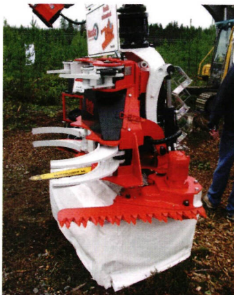
↑ Mense on tuonut markkinoille kouran, jolla voi myös raivata turhat pienpuskat pois. Toimintaperiaate on sama kuin Mensen raivauslaitteessa.
