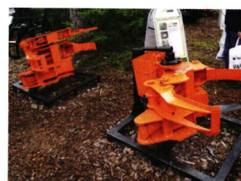
↑ Nummek OY:n Biojack 150 on 190 kiloa painava laite, joka sopii ennen kaikkea traktorikäyttöön. Sillä voi myös kuormata.
