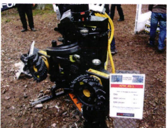
↑ Lähes 800-kiloinen AFM 45 L käy sekä ainespuun korjuuseen että kerääväksi energiapuukouraksi.
