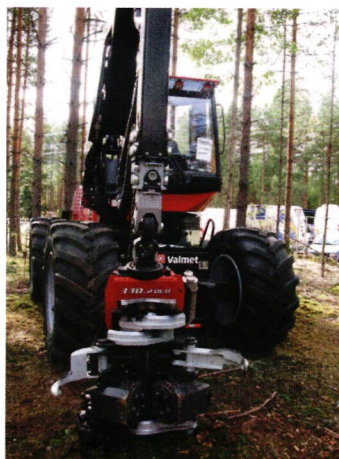
↑ Valmetin 330.2 Duo on energia- ja harvennuspuukourana Valmetin koneilla. Ominaisuudet antavat myös mahdollisuuden järempien puiden kaatoon.
