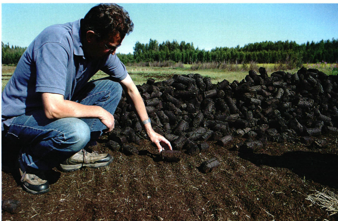
↑ Kerroskuivausmenetelmässä palaturve voi kuivua osittain seuraavan sadon alla suoja- gon säteily ja sateet eivät rasita palan rakennetta. Kuvat: Markku Jyrkkä
