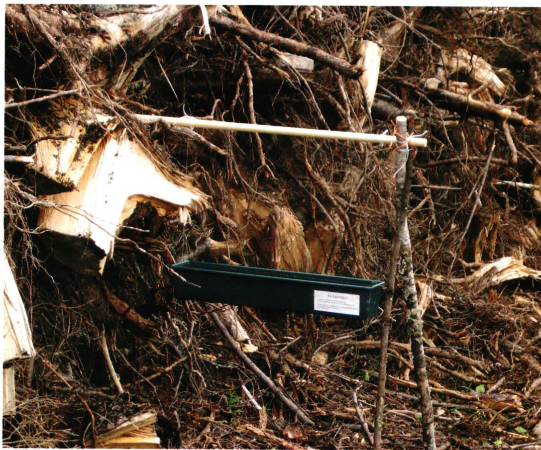
↑ Läpinäkyvällä muovivileyllä varustettu kookas hyönteispyydyks pysäyttää tehokkaasti kohdalle osuvat kuoriaiset.
