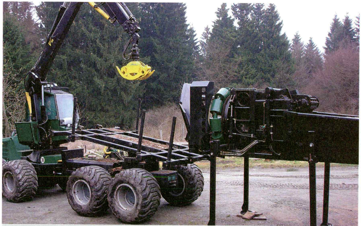
Paalaus sopii myös erinomaisesti yhdistelmäkonofilosofiaan, jossa samalla koneella tehdään kaikki työvaiheet: kaato, paketointi ja kuljetus.
