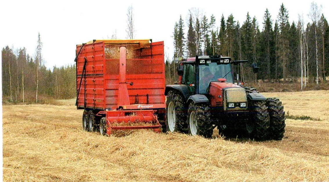
Tarkkuussilputun ruukohelven suurin ongelma on keveys, sillä kuljetuskustannukset nousevat helposti korkeiksi. Toisaalta erillistä silppuamista voimalaitoksessa ei tarvita, mikä säästää kustannuksia paaleihin verrattuna.
