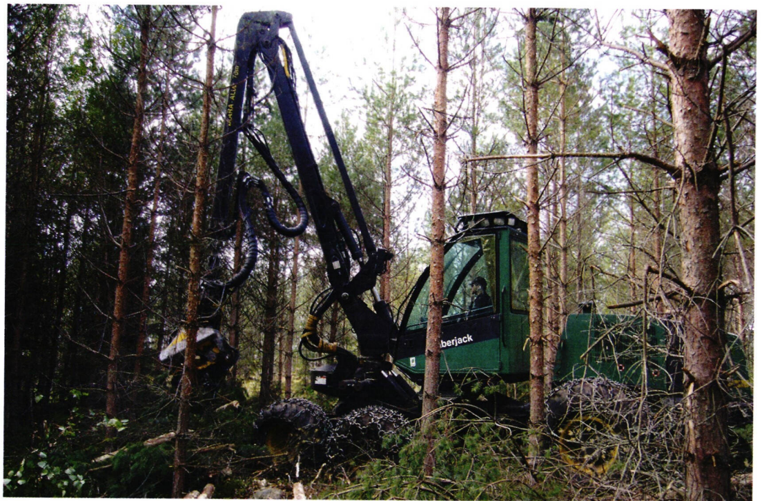
↑ Kuitu 10 cm-menetelmässä karsittiin kuitupuuta latvaläpimitaan 10 senttiä ja kuitupuun latvat ja pienemmät puut tehtiin karsimattomana energiapuuksi tarvittaessa kuljetuspituuteen katkaisten. Hakkuukoneena oli John Deere 1070/745 varustettuna joukkokäsittelykapälin.
