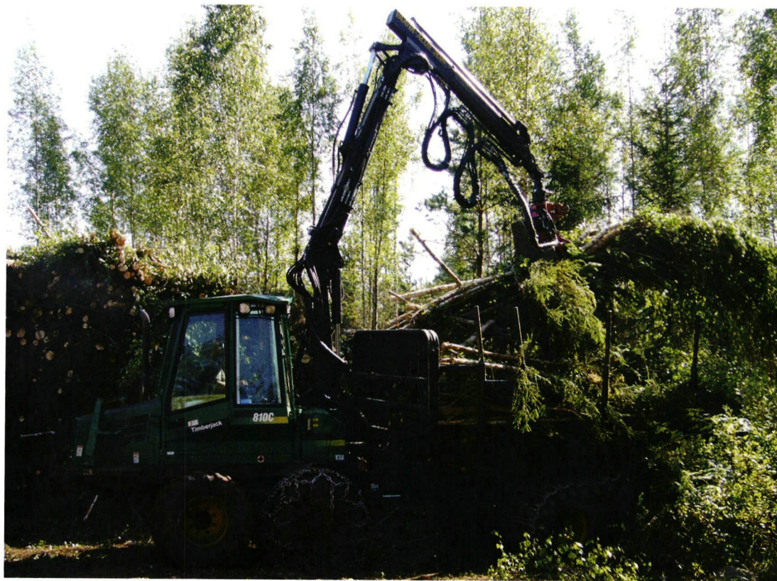
↑ Giljotiinikoneena oli Timberjack 810C varustettuna Nisula 280 -giljotiinihakkuulaitteella. Purkaminen giljotiinihakkuulaitteella oli hitaampaa kuin tavanomaisella puutavarakouralla.
