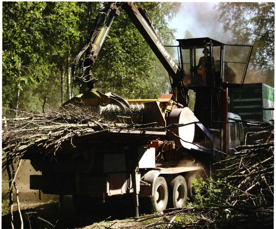
↑ Valtaosa pieniläpimittaisesta energiapuusta ja hakkuutähteistä haketetaan tienvarsivarastoille. Kuvassa ylivuotisen kokopuun haketusta Giant-rumpuhakkurilla. Valokuva: Kotimaiset Energiat Oy.
