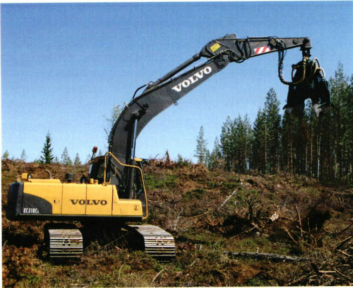
↑ Uusi tekniikka mahdollistaa muun muassa mäntykantojen noston.
