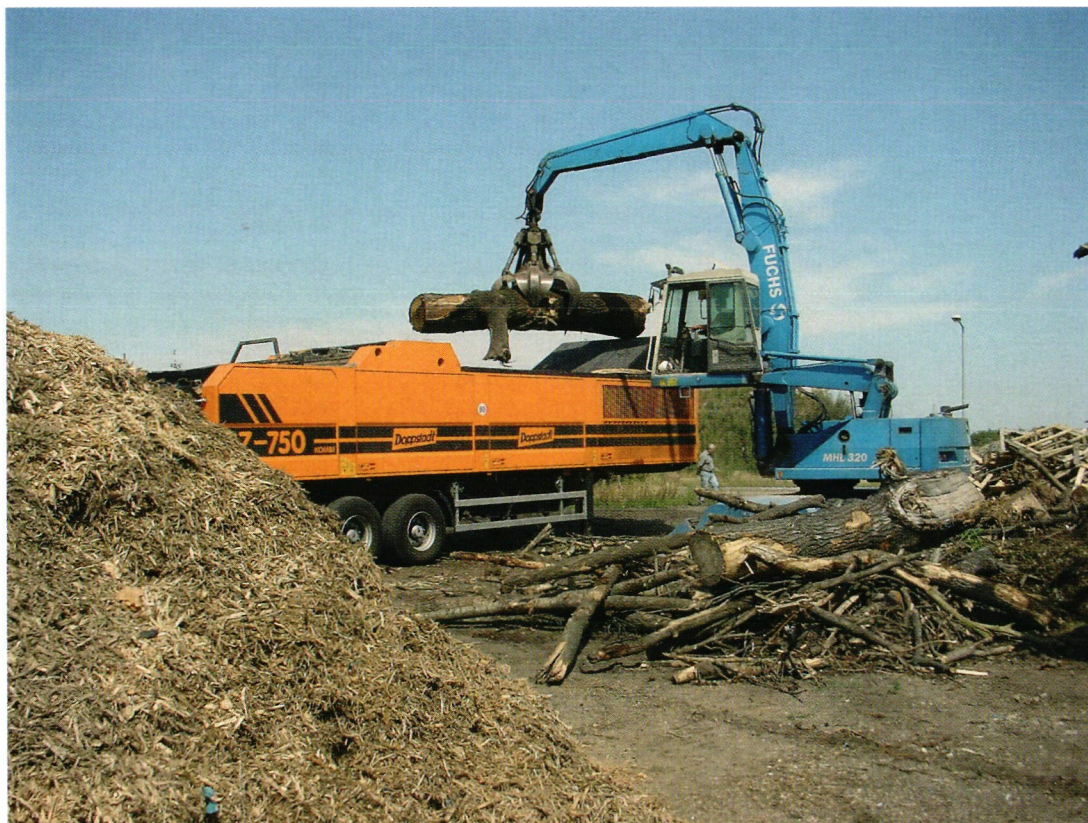
↑ Järeiden, terminaali- ja käyttöpaikkahaketukseseen soveltuvien hakkureiden ja murskainten määrä on lisääntynyt, kun entistä isompia metsähakemääriä on valmistettava. Kuvassa järeän runkopuun murskausta Doppstadt DZ750 -murskaimella. Valokuva: Jasto Oy
