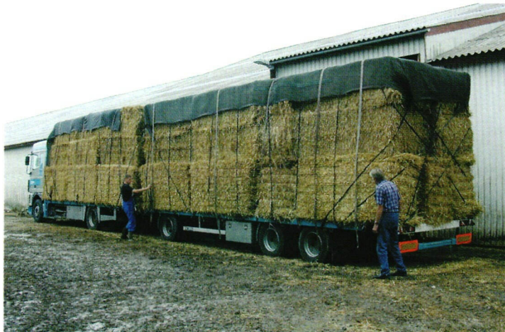
↑ Oikein latomalla saadaan sivulaidattomaan kuljetusautoon tehtyä tiivis paalikuorma.
