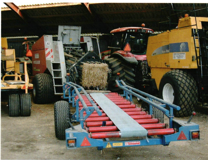
↑ Halvemmanmallinen paalinkeruuvaunu Welgerin perässä.
