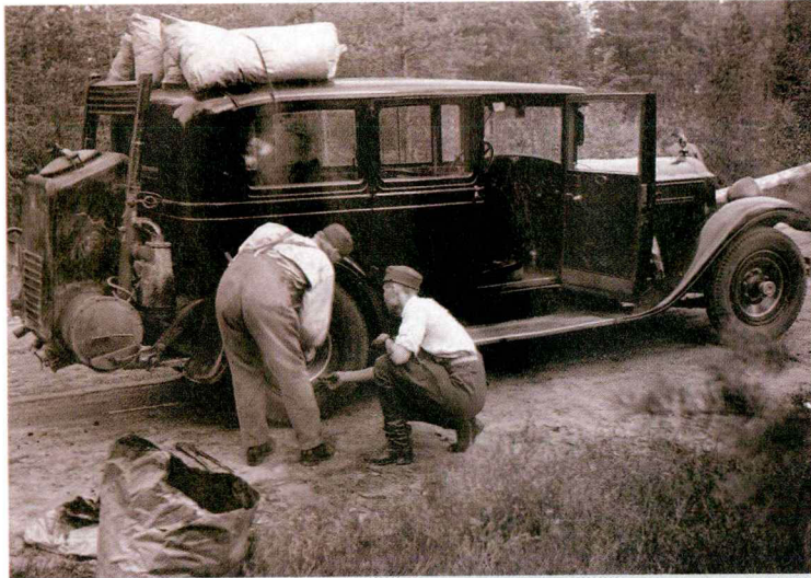
Viime sodissa suomalaiset pyörät pyörivät hääpöntöillä. Tänään puusta ja muusta biomassasta saataisiin tehokkaampiakin polttoaineita kuten biodieselä ja synteettistä bensiiniä. Synteettiset polttonesteet sopivat nykyaikaisiin ajoneuvoihin jopa paremmin kuin fossiiliset polttoaineet. (Kuvat: Sa-kuva)
