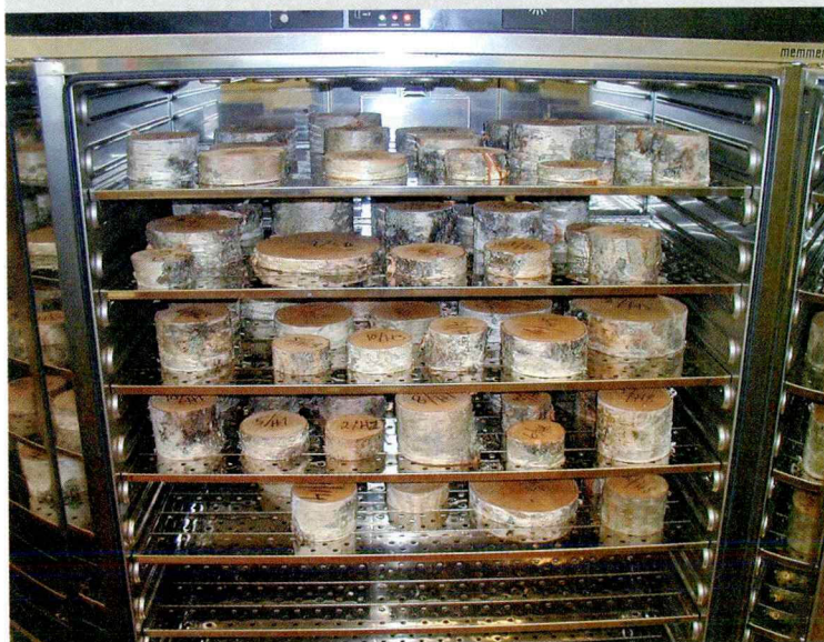
Tutkimuksessa verrattiin näytekiekkojen, pilkkeiden ja sahauspurujen kosteuk-sia. Näytekiekkoja kuivuu lämpökaapissa.
