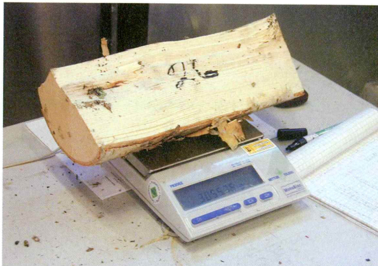
Lämpökaapissa kuivattaessa näytteet punnitaan ennen ja jälkeen veden haihuttamisen.
