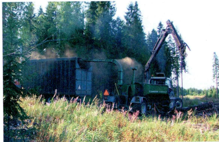
Rangat ja muu raaka-aine haketetaan suoraan konttiperävaunuun. Traktori-kontin tilavuus on 35, nuppiauton 45 kuutiota.
