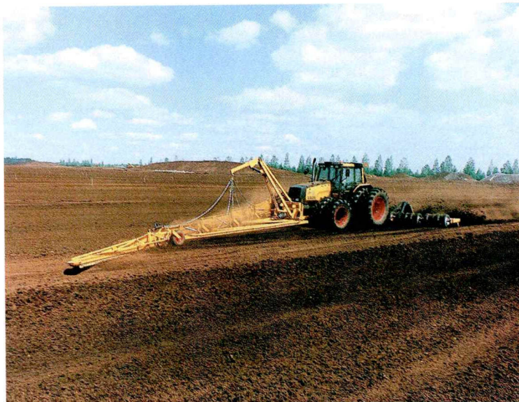
Konekehitystyön ansiosta turvetuotanto on pystytty pitämään kilpailukykyisenä. Kuvassa jyrsin-karheea –yhdistelmä.
