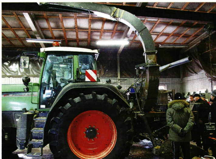
↑ Salix Maskiner AB:n protovaiheessa oleva isompi pajuhakkuri. Puun maksimihalkaisija saa olla 10 senttiä. Traktorilla ajetaan pellolla peruuttamalla.
