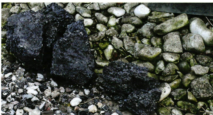
↑ Kuten näkyy, oljen tuhka sulaa helposti. Nämä kimpaleet ovat kaiketi olleet liian suuria tuhkaruuvien käsiteltäväksi.
