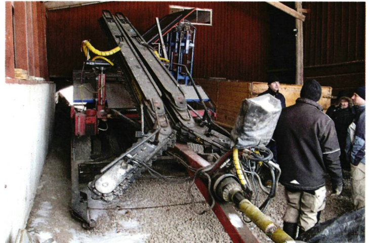
↑ Salix Maskiner AB:n valmistama hinattava pajunniputin. Kasvuston leikkaava ketjuterä näkyy vetoaisan alla etualalla.
