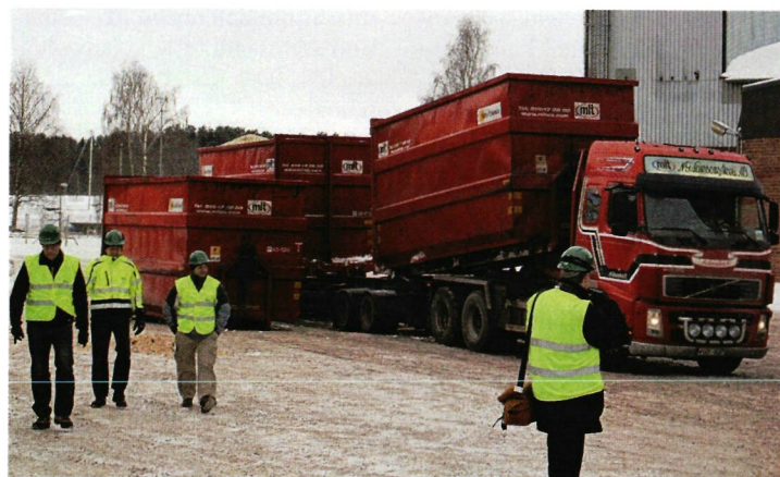
↑ Pajuhake tuodaan vaihtolava-autoilla pelloilta voimalaitokselle, jossa se sekoitetaan muuhun polttoaineeseen.
