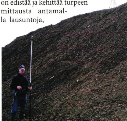
↑ Turveauman mittausta robottitaky-metrillä. Kuva Juha Laakso/ProAgria Etelä-Pohjanmaa
