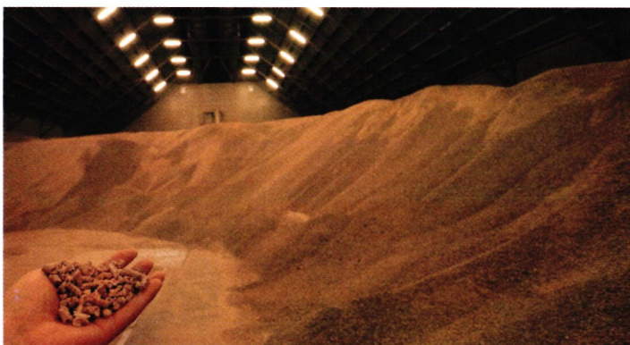
↑ Olkipellettejä Vattenfallin Amagerin laitoksen pellettivarastossa. Kuva: Samuli Rinne
