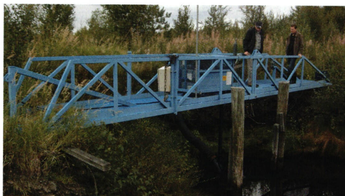
↑ Pumppaussillalla dieselmoottori käyttää Mamecin pengerpumppua Turveruukin työmaalla. Kuva: Esa Kallio
