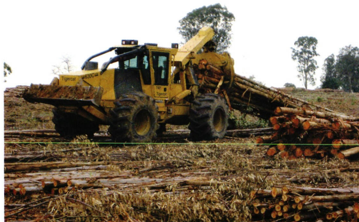
↑ Kuljetus tehdään kokorunkojuontona tienvarteen. Kuva: Kalle Karttunen
