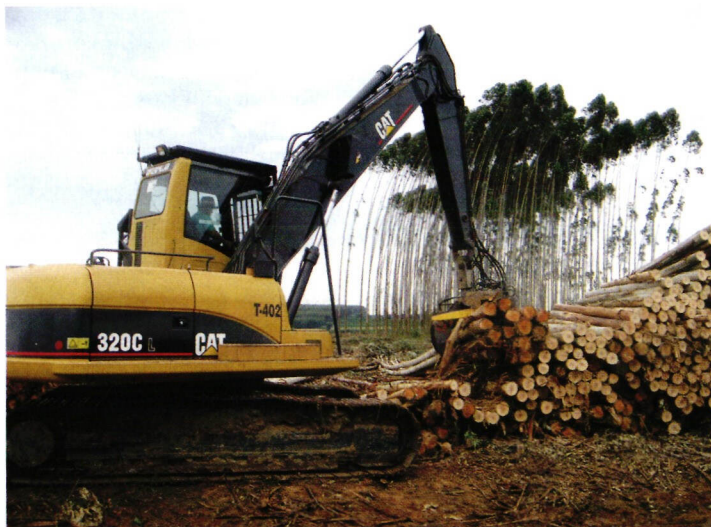
↑ Tienvarressa rungot pilkotaan pinoon kahden metrin pölleiksi. Kuva: Kalle Karttunen
