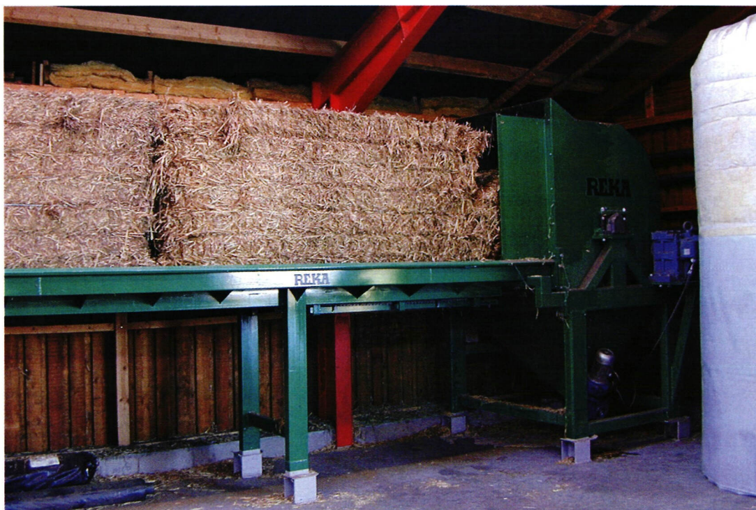
↑ Reka-järjestelmän paalirata työntää paaleja repijärumpua kohti. Kuvat: Timo Lötjönen
