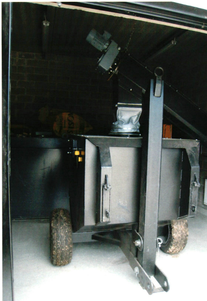
↑ Tuhkalle on oma varastovaunu. Yhdestä hakekuutiosta kertyy noin 200 litraa tuhkaa. Tuhka palautetaan ympärillä oleviin yhtiön metsiin.
