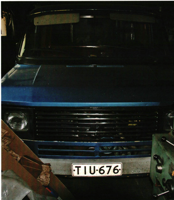
↑ Kangasojan oma jalostamo on tuottanut kaiken tarvittavan polttoaineen, noin 42 000 kiloa sekahaketta. Noilla eväillä Ford Transit -avolava on kulkenut 120 000 kilometriä kuuden vuoden kuluessa. Maantielle on tuprunnut hiilidioksidia ja vettä, ehkä hieman häkää. Molemmat palamistuotteet ovat jo tekemässä uutta kasvua tienvarsimetsiin.
