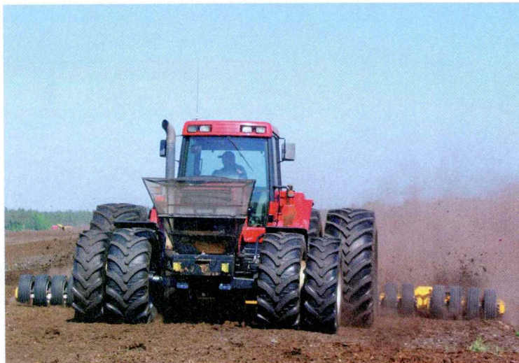
Jyrsinturvetta tuotetaan jyrsimällä turvetta suon pinnasta noin 25-44 millin syvyydeltä ja kuivattamalla ohut turvekerros auringon ja tuulen avulla tuotantokentällä.
