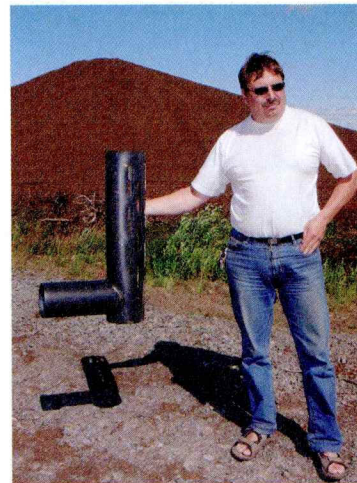
Turveruukin työnjohtaja Jouni Tuomela kertoo sarkaojan päässä olevan sihtiputken keräävän tehokkaasti ojassa virtaavaa kiintoainetta ja lietettä jo ennen varsinaista vedenpuhdistusta pintavalutuskentällä.
