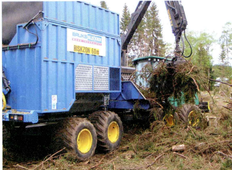
Palstahaketus on vielä varsin yleinen hakkuutähdehakkeen tuotantomenetelmä Ruotsissa. Vuonna 2003 palstahaketus-tuotantoketjulla tuotettiin vajaa yksi terawattitunti (noin 0,5 milj. m 3 ) hakkuutähdehaketta Ruotsissa. Kuvassa Bruks Klöckner AB:n valmistama 805 CT -rumpuhakkuri, joka on asennettu hakekontteineen Timberjack 1410B -kuormatruktorin kuormatilaan. (Valokuvat: Metsäteho Oy)
