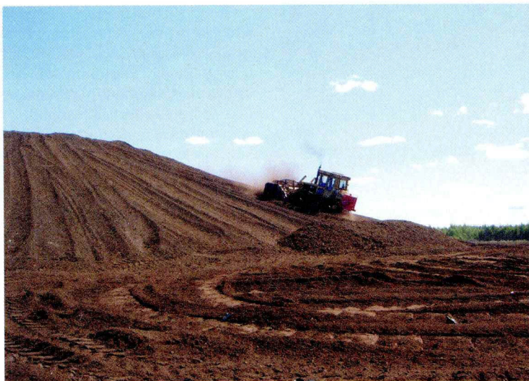
Puskukoneella tehty pyramidin mallinen keskusauma on tiivis ja säilyttää turpeen hyvin. Aumasta turve kuljetetaan talvella läheisiin energialaitoksiin, esimerkiksi Oulun Toppilan voimalaitokselle.
