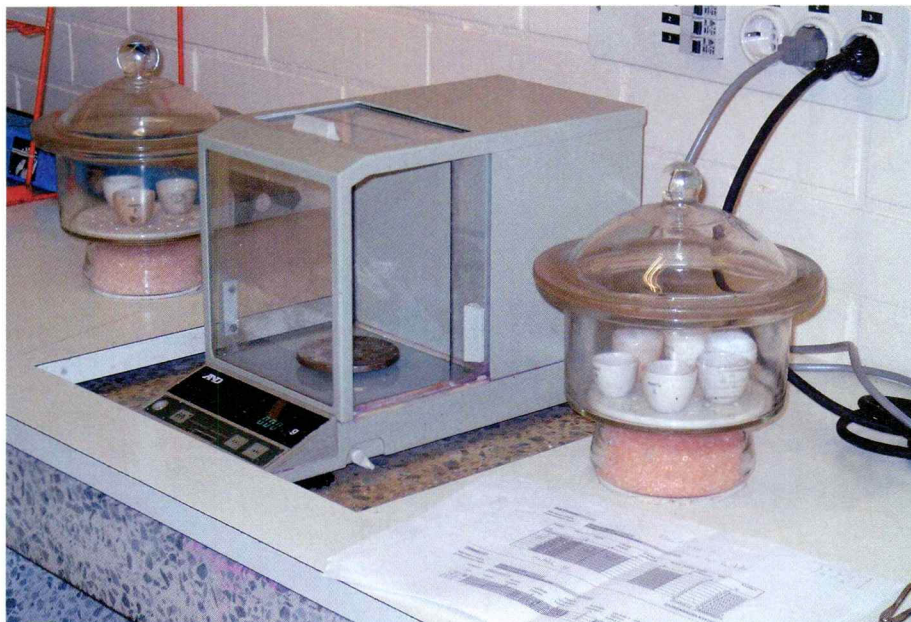
Tuhkanäytteet analysoidaan 0,0001 g tarkkuudella, hehkutusupokkaat eksikaattorissa.
