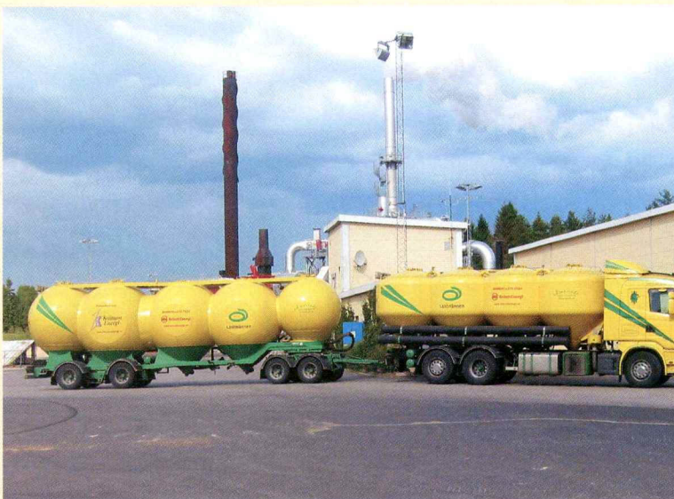
Parasta antia olivat ruotsalaiset pellettijärjestelmät. Pellettikuljetukseen on käytössä erikoisvalmisteinen kuljetusauto. Siinä on kullakin tilaajalla oma säiliönsä, josta polttoaine tyhjennetään käyttäjän siiloon.
