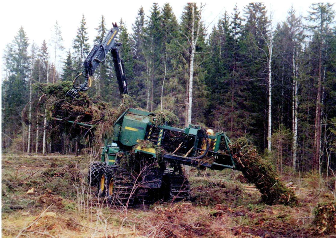
Kun hakkuutähteitä paalataan hyväkuntoisista kasoista, työn tuottavuus nousee ammattitaitoisella kuljettajalla selvästi yli 20 paalin käyttötunnissa.
