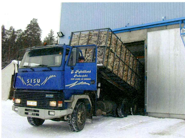
Vaihtolavojen lasku kuorma-autosta kuivauskamariin.
