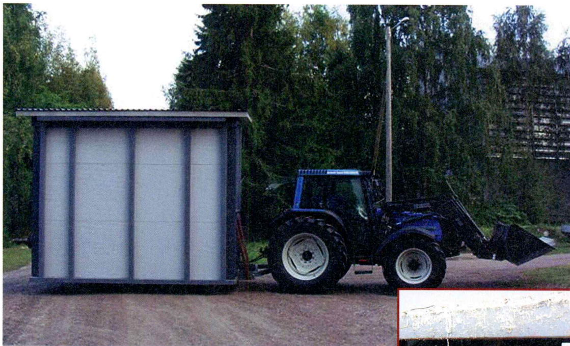
30 kuution polttoainevaraston alustan aisa kiinnitetään traktorinvetokoukkuun, jolloin etupää nousee. Takapää kohoaa hydraulisesti hallittavien pyörien varaan. Mitat täyttävät tieliikenneasetuksen säädökset, jolloin siilo voidaan siirtää vaikkapa vaihtolavalla.
