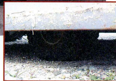
30 kuution polttoainevaraston alustan aisa kiinnitetään traktorinvetokoukkuun, jolloin etupää nousee. Takapää kohoaa hydraulisesti hallittavien pyörien varaan. Mitat täyttävät tieliikenneasetuksen säädökset, jolloin siilo voidaan siirtää vaikkapa vaihtolavalla.
