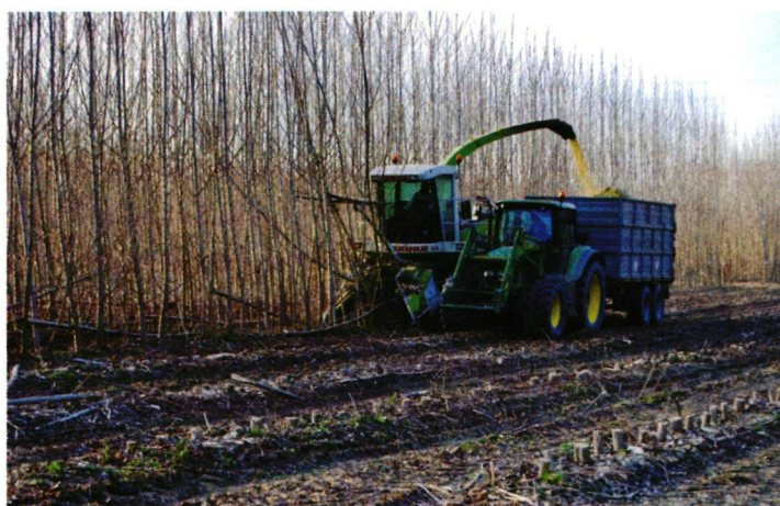
↑ Poppelin korjuuta ja haketusta Italiassa. Samalla tekniikalla voidaan korjata myös energiapajua. Kuva: M. Cocchi
