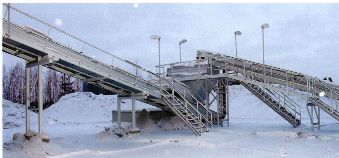
↑ Hakevarastosta jauhimelle on kaksi kuljetinta, joiden kulmauksessa on kivenerotin sekä magneetti varmistamassa, ettei isoja vahinkoja pääse syntymään.
