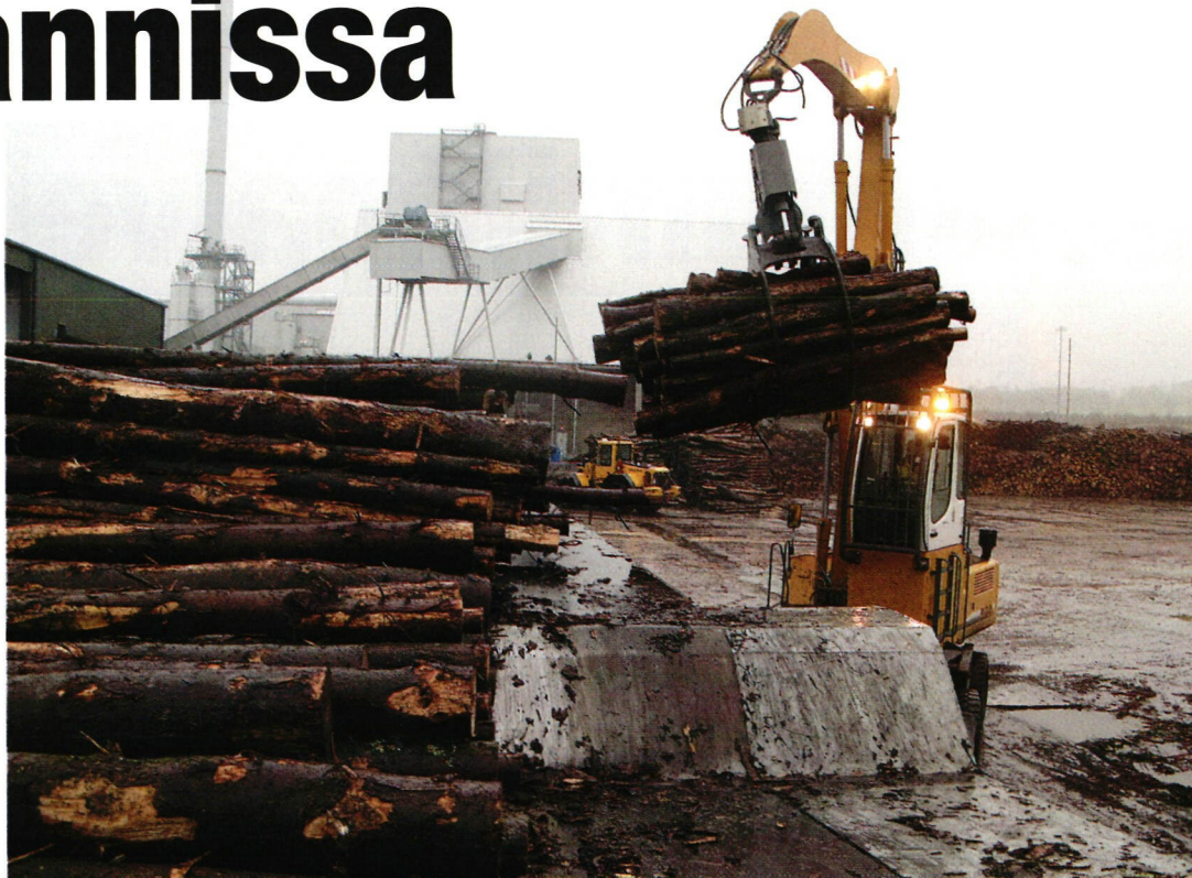
➔ Energiapuuta syötetään hakkuriin. Taustalla EON in voimalaitos.
