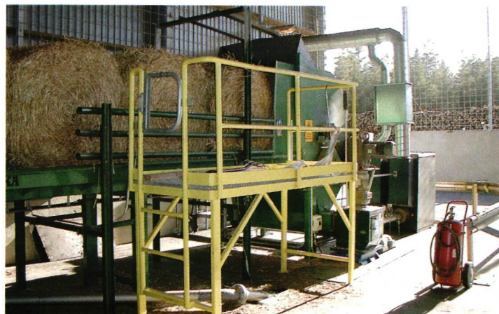
↑ Ruokohelpipaalien murskausta ja sekoitusta kahdella eri tavalla. Kustannustehokkuuden takia voimalaitosten kannattaisi pyrkiä siirtymään auto- maattitoimisiin murskaus- ja syöttölinjoihin
