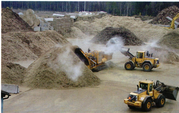
↑ Ruokohelpipaalien murskausta ja sekoitusta kahdella eri tavalla. Kustannustehokkuuden takia voimalaitosten kannattaisi pyrkiä siirtymään auto- maattitoimisiin murskaus- ja syöttölinjoihin
