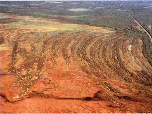
↑ Pohjanmaalla Tornion Porin seudulle saakka esiintyy soilla hiekkavaljeja, jotka voivat pirstoa turvetuotantoalueen. Vihreät kaarrot ovat hiekkaa ja jatkuvat turpeen sisälle. Kuvassa Revonneva.
