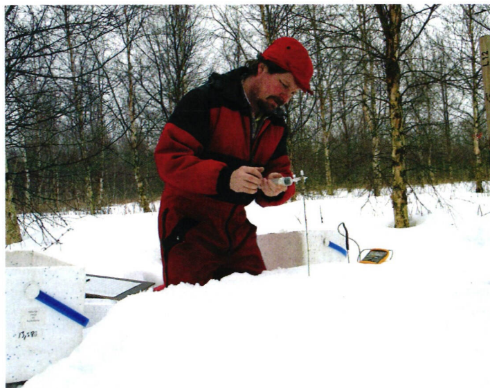
↑ Lumigradienntimenetelmällä tehtävää kaasunäytteenottoa istutuksessa koivikossa entisellä suopellolla. Kuva: Jyrki Hytönen
