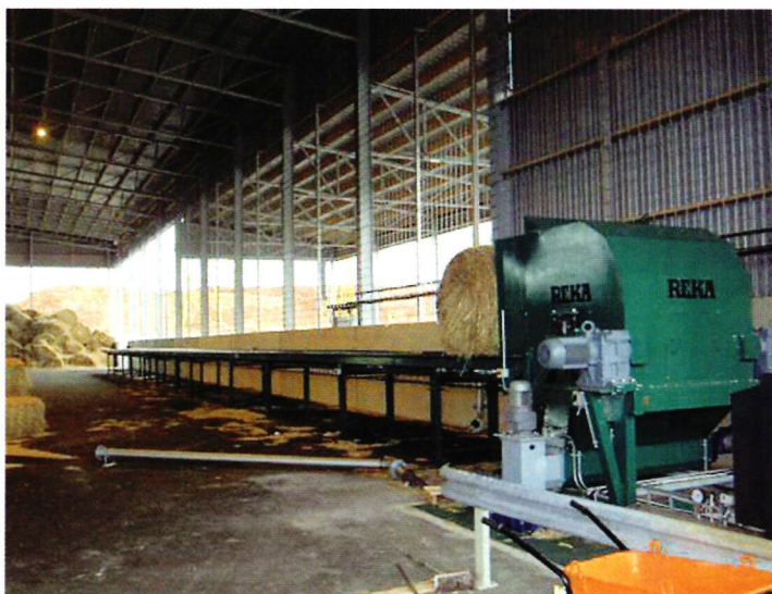
↑ Myös Vapon Ilomantsin voimalaan on tulossa tanskalaisvalmisteen, 40 metrin pituinen ruukohelven murskauslinja tänä vuonna. Sen varastoon mahtuu kaikkiaan 6000 suurkanttipaalia. Kuva Kokkolan Voiman linjasta.
