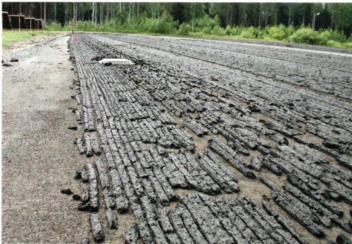
↑ Uudella turvetuotantomenetelmällä korjattua polttoturvetta kuivatuskentällä. Kuva: Sakari Sarkkola
