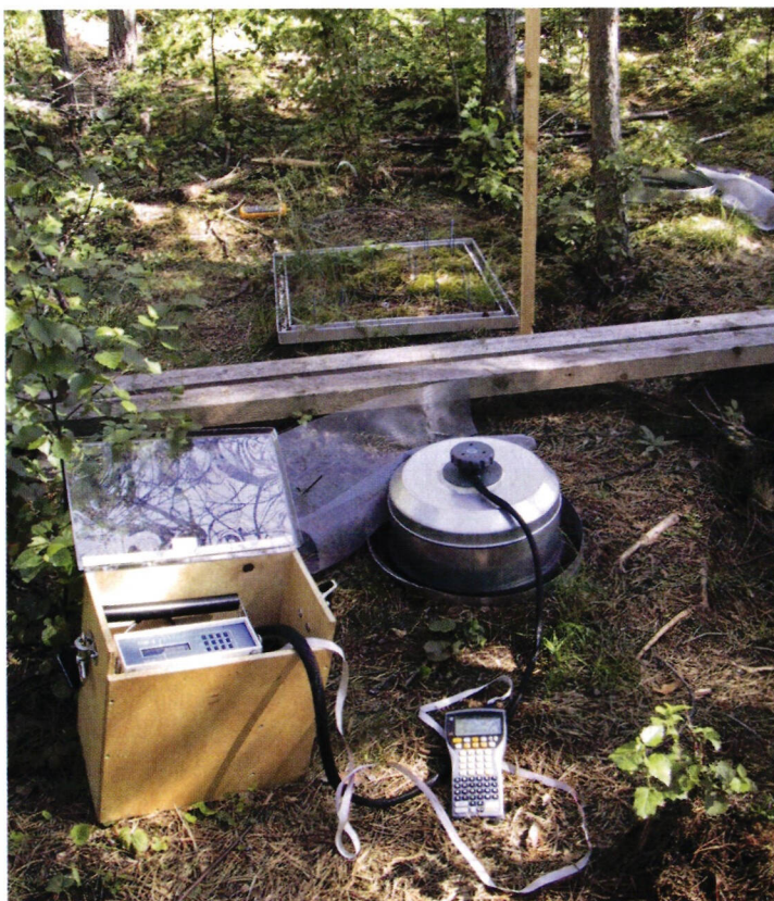
↑ Maahengityksen mittauslaitteistoa metsitetyllä suopellolla. Kuva: Mikulas Cernota
