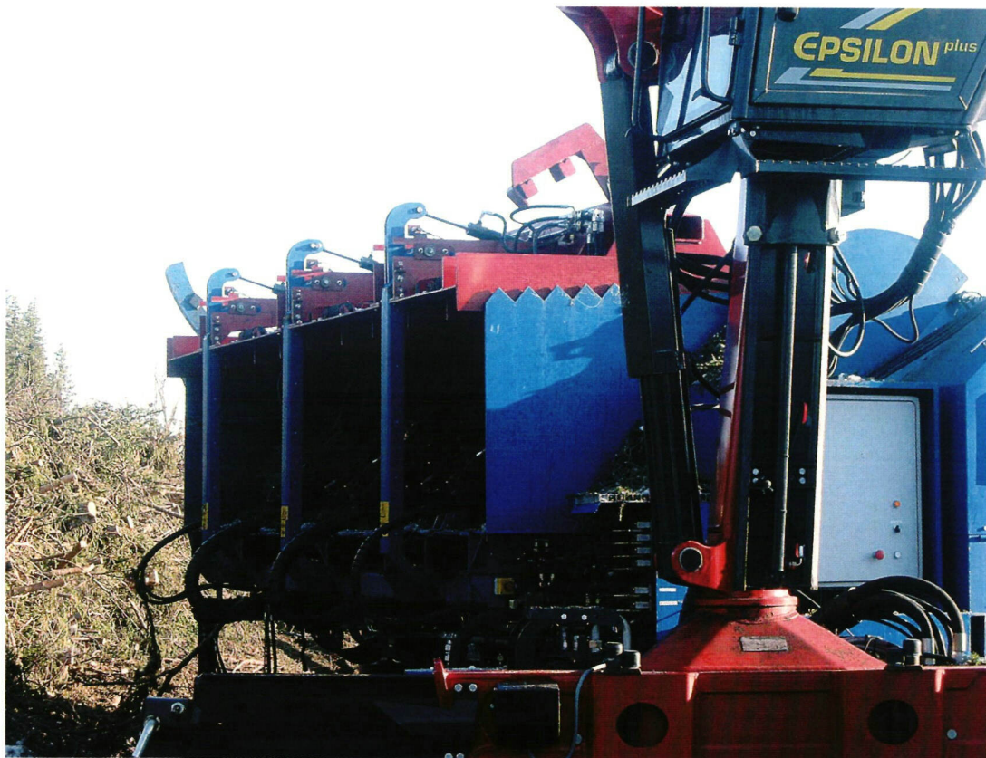
↑ Puristusvaihe on käynnissä. Punaiset rautaiset seinät painavat 70 tonnin voimalla latvusmassaa kokoon.
