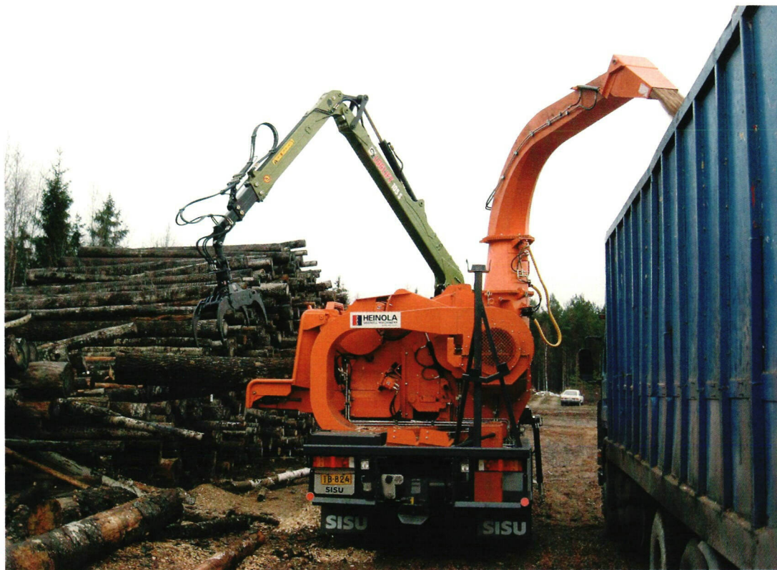
↑ Lahon, järeän runkopuun haketusta Heinola 1310RML -rumpuhakurilla terminaalissa. Valokuva: Heinolan Saha-koneet Oy.
