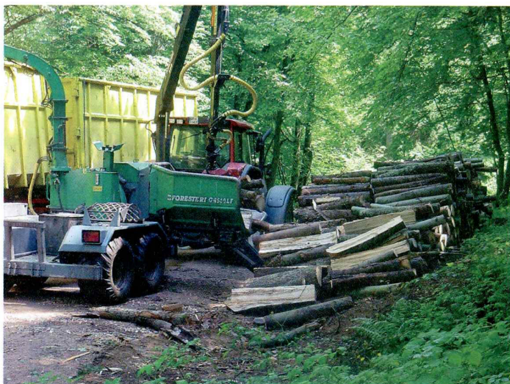
Puutavaran tienvarsihaketuista Charna Bialystokissa. Kuorma oli matkalla lastulevytehtaalle. Suomalainen korjuuteknologia on jo tuttua. (Kuva: Arvo Leinonen/VTT).
