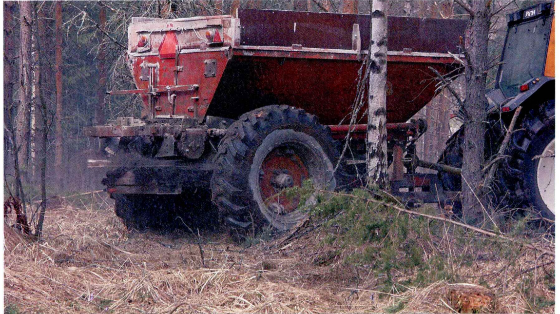
Bioliete-tuhkarakeita levitetään traktorivetoisella kalkinlevittimellä. Kosteat rakeet eivät pölise. Vaikeampaan maastoon kuormatraktorialustainen levitin on parempi ratkaisu.
