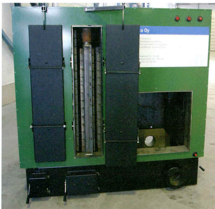
Sivusta puhdistettavat kattilat helpottavat niiden sijoittamista vanhoihin, mataliin kattilahuoneisiin, jollaisia on teollisuuskiinteistöissä ja koulurakennuksissa.
