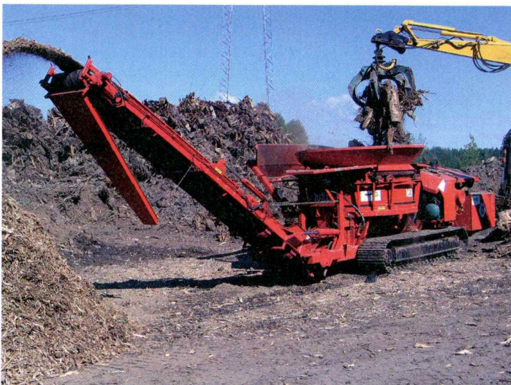
Valtaosa kannoista murskataan käyttöpaikalla. Vajaa 20 prosenttia murskattiin terminaaleissa 2005. Kuvassa tela-alustainen Morbark Tub Grinder 1200 -murskain murskaa kantoja terminaalissa Kehä III:n kupeessa Vantaalla.
