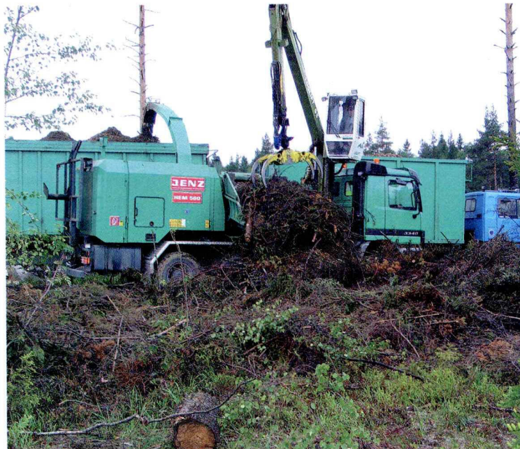
Hakkuutähteistä yli puolet haketettiin tienvarsivarastoilla 2005. Kuvassa Jenz HEM 560D -rumpuhakkuri hakettaa hakkuutähteitä metsäautotien varressa. Valokuvat: Ideachip Machine Oy
