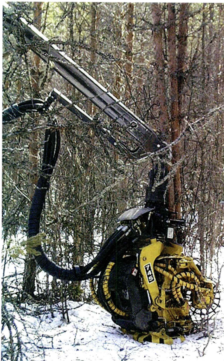
Timberjack 745 ja sen yläosassa Outokummun Metalli Oy:n joukkokäsittelylaite (Kuva Outokummun Metalli Oy).
