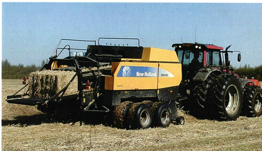
↑ Suurkantipaalaimeen perustuvat korjuu-tuotantoketjut ovat edullisimpia, mutta koneet ovat harvinaisia Suomessa. Kuva: Timo Lötjönen
