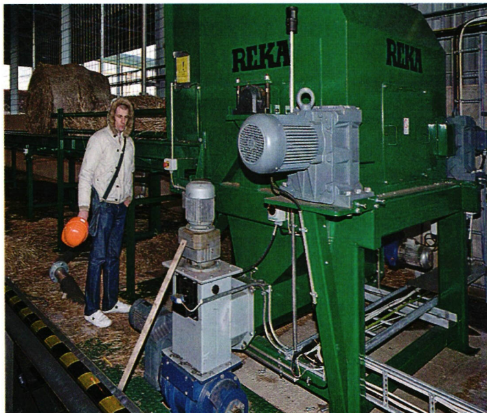
↑ Oljelle suunniteltu kevytrakenteinen murskain. Kuva: Samuli Rinne
