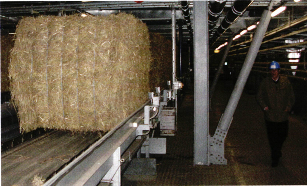
↑ 500 kiloa painava olkipaali menossa kattilaan. Oljen käyttöä on systemaattisesti kehitetty Tanskassa.
