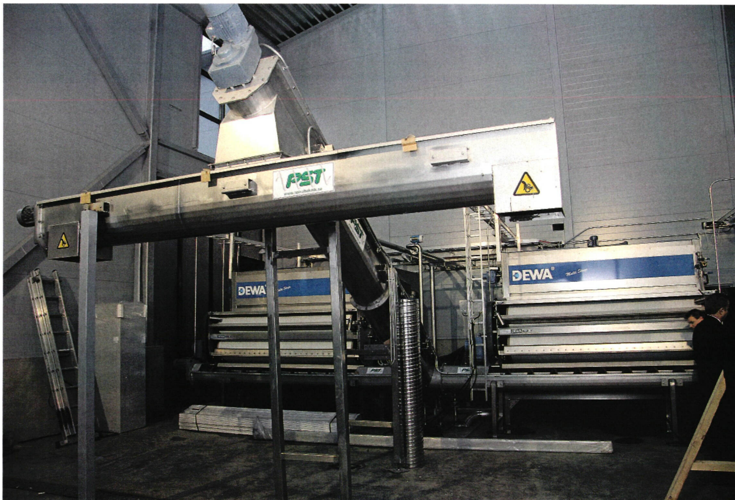
↑ Kiintoaineksestä tehdään jälkikäsittelyssä rakeista kierrätyslannoitetta.
