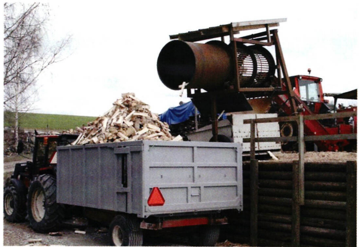
↑ Polttopuun ajaminen rummun läpi takaa hyvälaatuisen puhtaan lopputuotteen. Kuva: Matti Turtiainen
